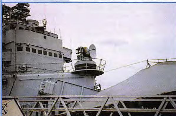
Radar DRBC 32 C conduite de tir des tourelles simples 100 mm.
