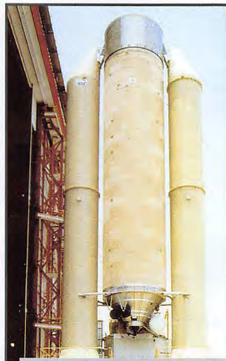
ARIANE 5 - Vol 502. Le premier étage en cours d'assemblage: les réservoirs hydrogène/oxygène liquides et latéralement les boosters à poudre.
