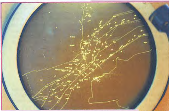
Détails de l'écran radar : on y voit la côte française à droite, la côte anglaise à gauche. Entre les deux, les deux voies. Les points représentent les bateaux en navigation.
