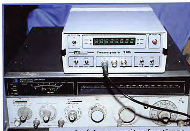
Le fréquencemètre fonctionne, on teste sa sensibilité.
