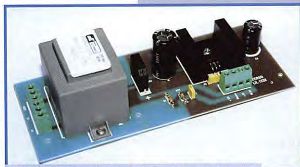
Sur l'alimentation, il faudra inverser DZ1 (ce n'est pas fait sur la photo).
