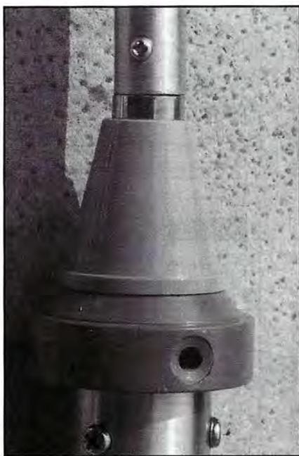
Cette petite vis de fixation, au-dessus de la self est le point faible de l'antenne.
