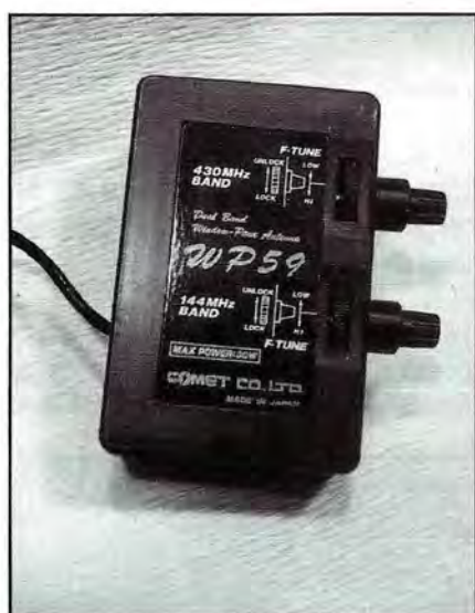
Pour le réglage ne pas agir sur la longueur du brin mais sur le bouton de réglage
