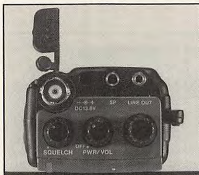
Ce scanner de poche (Icom IC-R1) dispose d'une sortie "LINE OUT" pour le raccordement d'un magnétophone ou d'un ampli extérieur.
