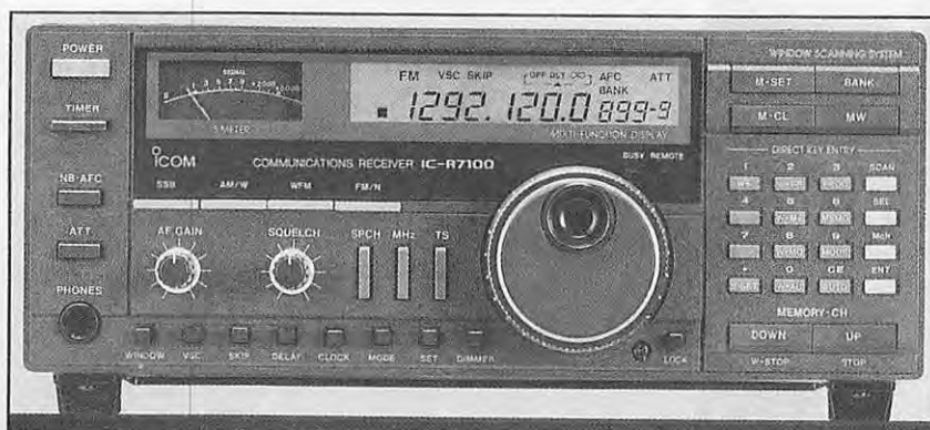
Matériel de table couvrant de 25 à 1300 MHz, l'Icom IC-R7100 est un excellent récepteur tous modes.
