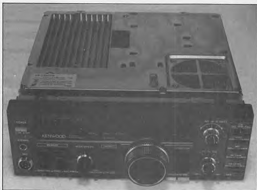
Le TS-140S/680S sans son boîtier. Une construction robuste.
