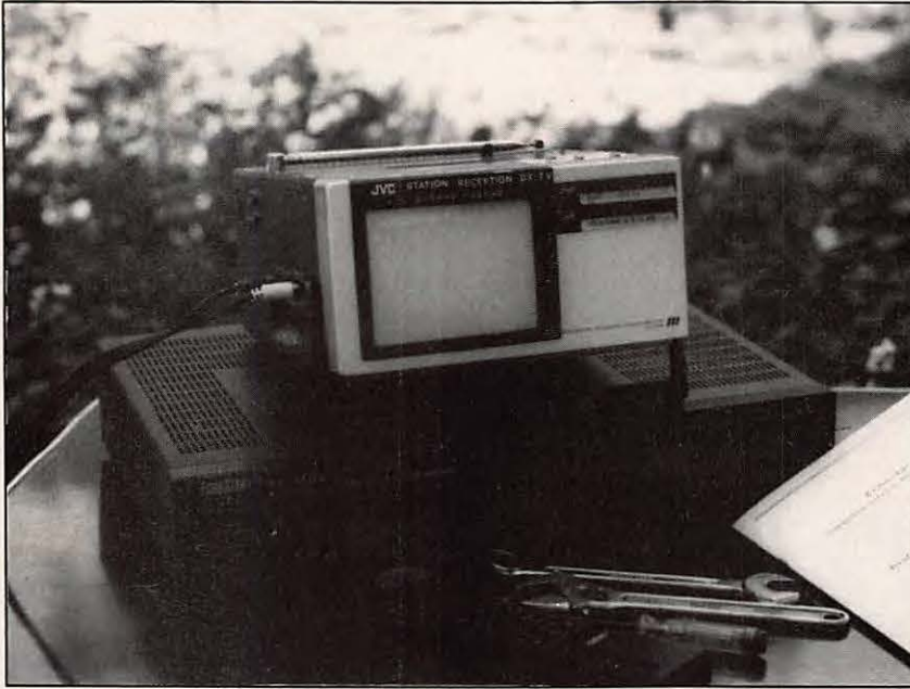
Photo 2 : Le système extérieur d'aide et de contrôle du positionnement de l'antenne. En fait, l'équivalent de la station intérieure avec un TV portable !
