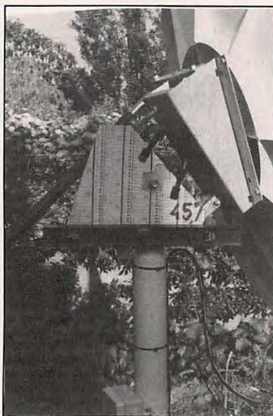
Photo 5 : Réglage de l'inclinaison de l'axe polaire de la parabole (ici, élévation insuffisante).
