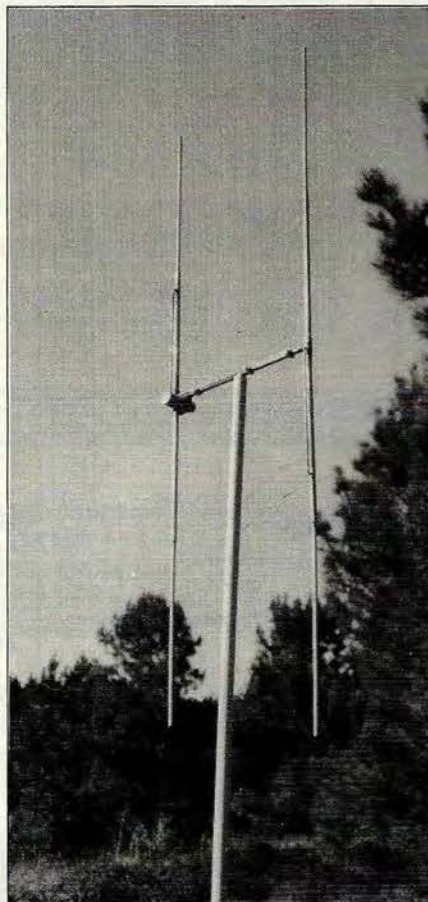
Photo A : Les 2 HB9CV 2 m et 70 cm, sur un même support.
