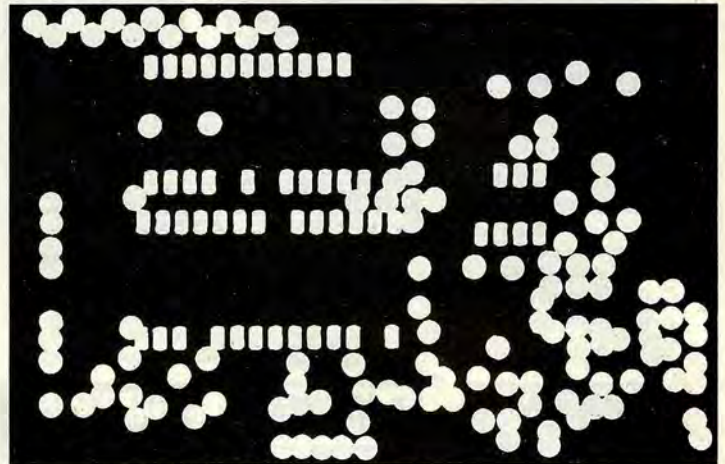
Figure 3b : Circuit imprimé côté composants.
