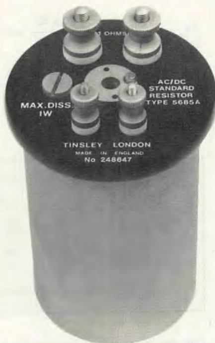
Une résistance étalon de 1 \Omega
