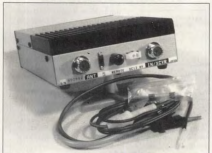
La face arrière et les câbles alimentation et antenne. Remarquez le fusible de rechange...
