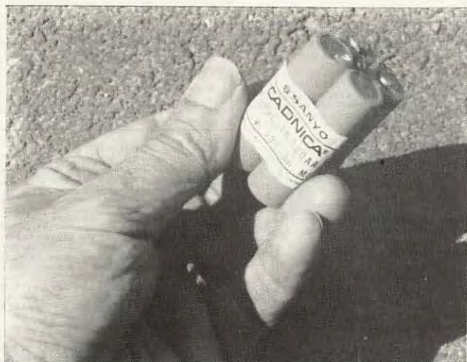
Photo 2 : Groupement de 4 éléments destiné à l'alimentation d'un téléphone à distance.
