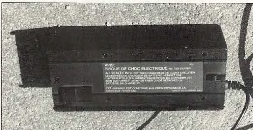
Photo 7 : Chargeur spécial (pour la batterie de la photo 4). A l'instar des matériels professionnels, il comporte des systèmes sophistiqués de protection et de charge rapide/lente.
