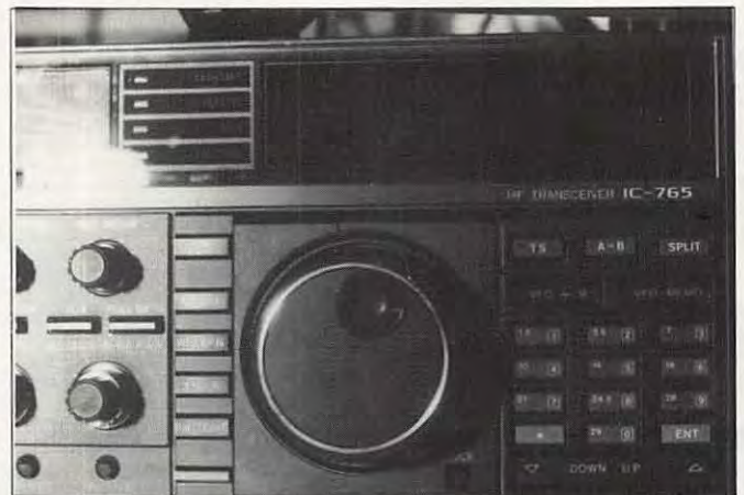
Au centre de l'appareil, les commandes de gammes et le bouton principal de variation de fréquence.
