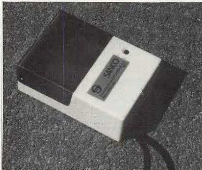
Photo 5 : Chargeur de batterie simple pour 4 éléments LR6
