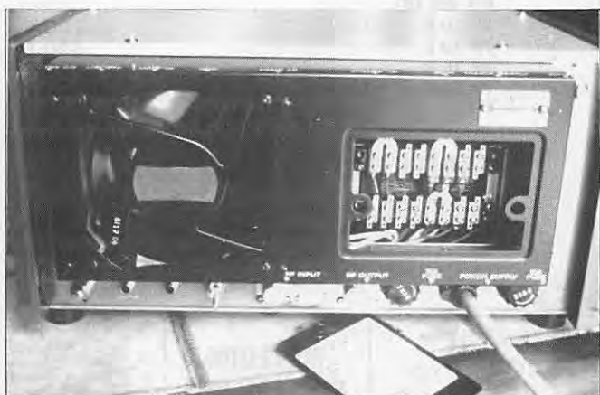
L'arrière de l'amplificateur TL-922 avec les straps des tensions. Le couvercle porte toutes les instructions nécessaires.
