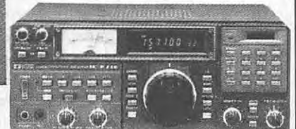
ICOM - ICR 71E. Récepteur tous modes de 100 kHz à 30 MHz, modes SSB/AM/RTTY/CW, FM en option. De nombreuses innovations techniques. Prix : 9500 F
