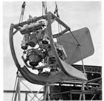
ZUM TITELBILD: Das Schleppgestell für die Tiefsee-Fernsehanlage wird an Bord des Forschungsschiffes Valdivia gehievt. Es wird aus einer Tiefe von rund 5000 m Fernsehbilder übertragen, um den Meeresboden nach Manganknollen absuchen zu können. An dem Schleppgestell sind außer der Fernsehkamera zwei Fotoapparate, drei Blitzlichtscheinwerfer und zwei Punktstrahler als Maßstabmarkierung auf dem Meeresboden montiert. Siehe Seite 247 dieses Heftes. (Aufnahme: Ringer)
