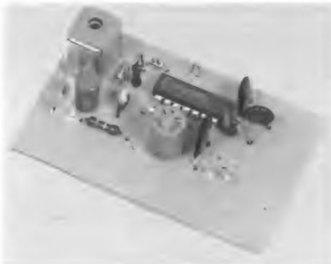
Bild 8. Aufbau des Meßdemodulators nach Bild 4
