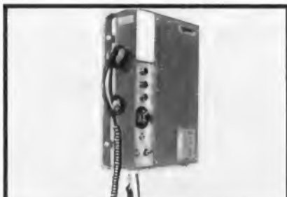
UKW-Sprechfunkgerät 801 A zum Einsatz im internationalen Seefunk, 24 Kanäle – 25 kHz Kanalraster – 15 W Sen- deleistung FTZ-Nr.: C-46 3837
