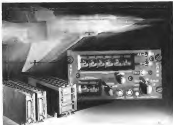
▲ Extrem kleine Fernsehkamera, bei der die eigentliche Aufnahmeröhre getrennt vom Versorgungsteil an exponierten Stellen, z. B. an der Außenseite von Flugzeugen, angebracht werden kann
