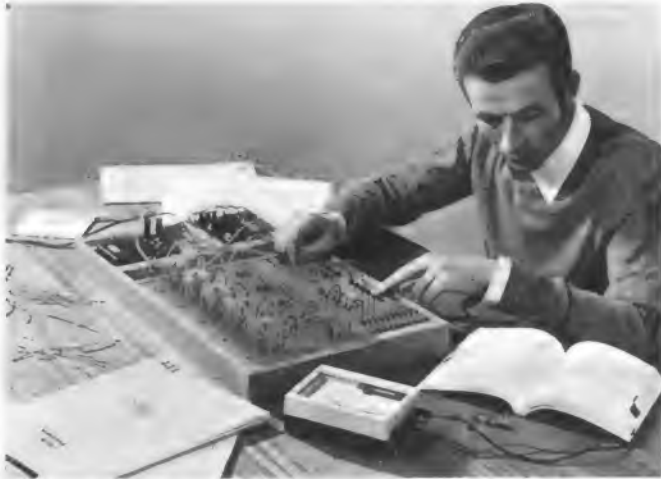
Heimexperimentierplatz mit Digital-Experimenter des Lehrganges „Digital-Elektronik“
