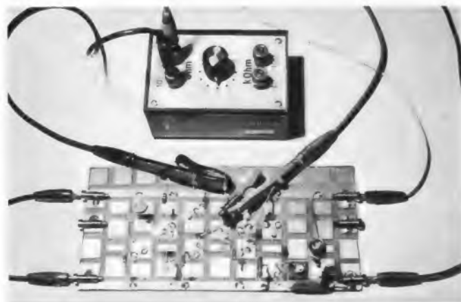
Bild 2. An den Anschlußdrähten der Bauteile lassen sich gut Meßkabel anschließen
