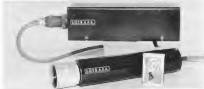
▲ Extrem kleine Fernsehkamera, bei der die eigentliche Aufnahmeröhre getrennt vom Versorgungsteil an exponierten Stellen, z. B. an der Außenseite von Flugzeugen, angebracht werden kann
