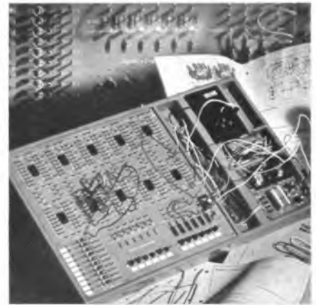
ZUM TITELBILD: Ein wichtiger Teil des ITT-Fachlehrganges „Digital-Elektronik“ ist der Experimentierkasten, mit dem die theoretisch gewonnenen Erkenntnisse in die Praxis umgesetzt werden. Dieser sogenannte Digital-Experimentierkasten läßt sich mit bis zu zehn integrierten Schaltungen bestücken. Eingebaut sind bereits u. a. sieben IS für die prellfreie Eingabe von Impulsen und für die automatische Taktversorgung. Der Bedienteil besitzt darüber hinaus drei dynamische und sechs statische Eingabemöglichkeiten. Der Anzeigeteil enthält zehn transistorbestückte Anzeigestufen. Mit dem Thema Fachlehrgänge befaßt sich ausführlich unser FUNKSCHAU-Gespräch auf Seite 221.
