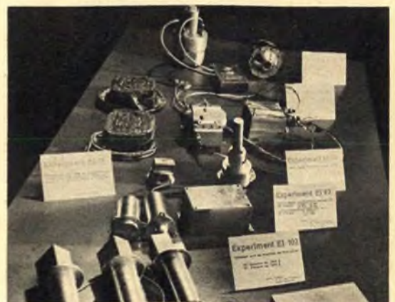
Bild 2. Die auch „Experimente“ genannten wissenschaftlichen Instrumente des Satelliten Azur. Sie wiegen zusammen 17 kg
