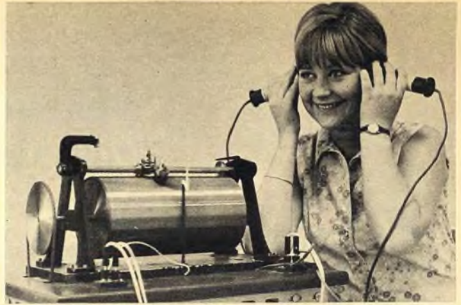
Bild 3. Poulsens erstes Telegraphon (1898) mit einer Drahtgeschwindigkeit von 2 m/s (DRP 109 559)
