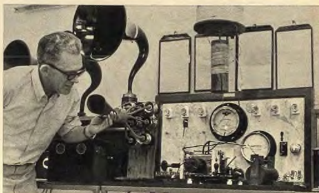
Bild 1. Der erste Telefoniesender von Poulsen in Labormuseumsausführung. In der Mitte die Flammenkammer mit Rohren für die Wasserstoffversorgung, davor eine Spule des magnetischen Gebläses, links das unmittelbar in die Antenne geschaltete Siebenfach-Kohlemikrofon
