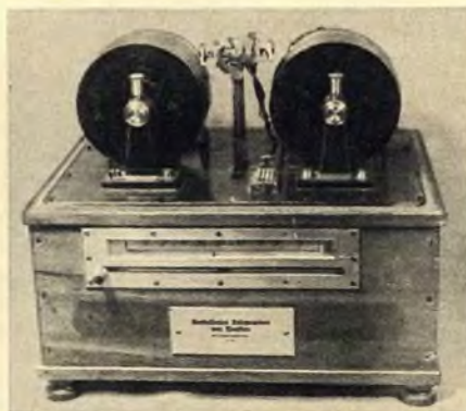
Bild 4. Verbessertes Poulsen-Telegraphon für Schnelltelegrafieempfang mit zwei Spulen für Stahldrahtstreifen (1904)
