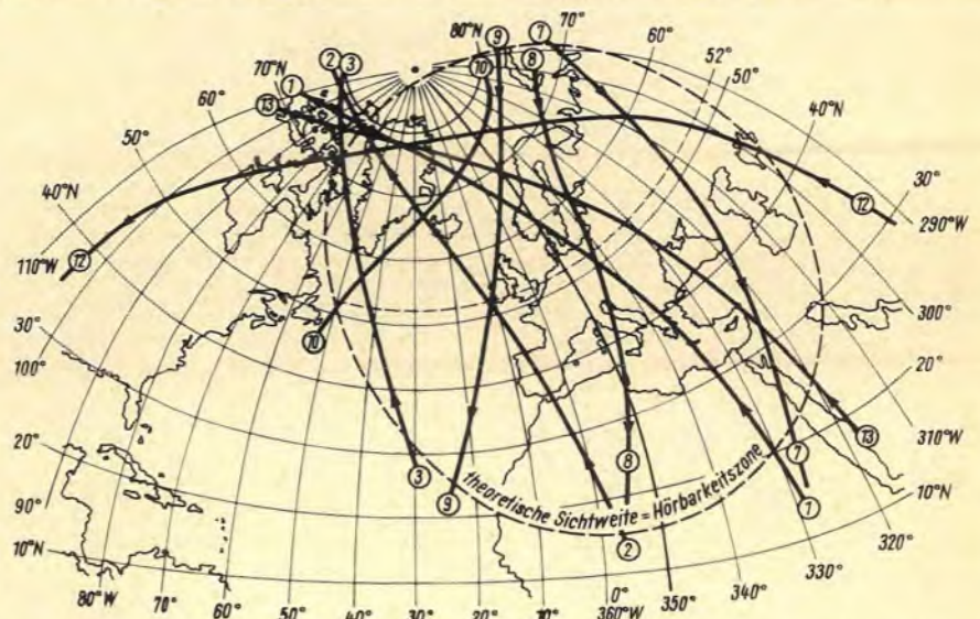
Bild 1. Errechnete Oscar-Bahndaten. Die Zahlen nennen die Umläufe, nicht aufgeführte sind nicht hörbar
