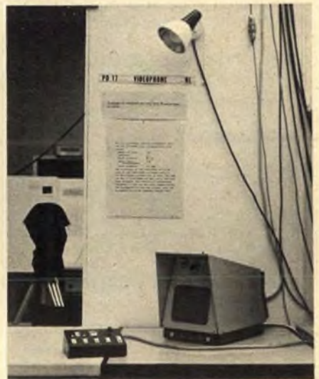
Bild 5. Fernsehtelefon Vidophone. Vidicon-Kamera und Lautsprecher sind im Bildröhrengelände untergebracht, das Mikrofon steckt im Bedienungskästchen links. Diese Aufnahme zeigt den typischen Aufbau aller ausgestellten 110 Forschungsarbeiten
