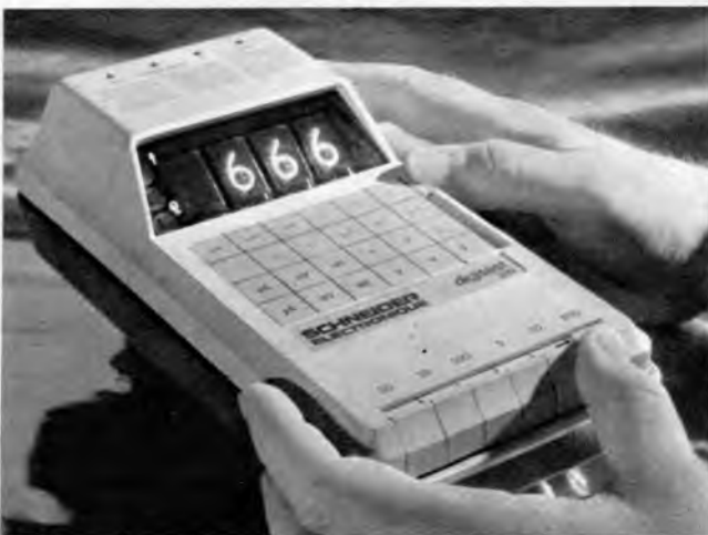
Links: Bild 11. Digitest 500, ein sehr handliches Digital- Vielchmeßinstrument mit Drucktastenedienung (Schneider Electronique)
