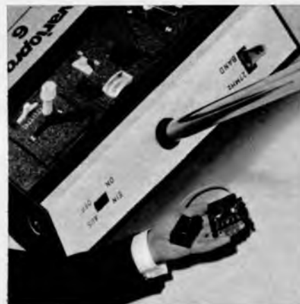
Bild 1. Zwei Neuentwicklungen für die drahtlose Fernsteuerung von Grundig: der Fernlenksender vom Typ Varioprop 6 und der Fahrtregler-Baustein mit angeschlossener Leistungs-Endstufe
