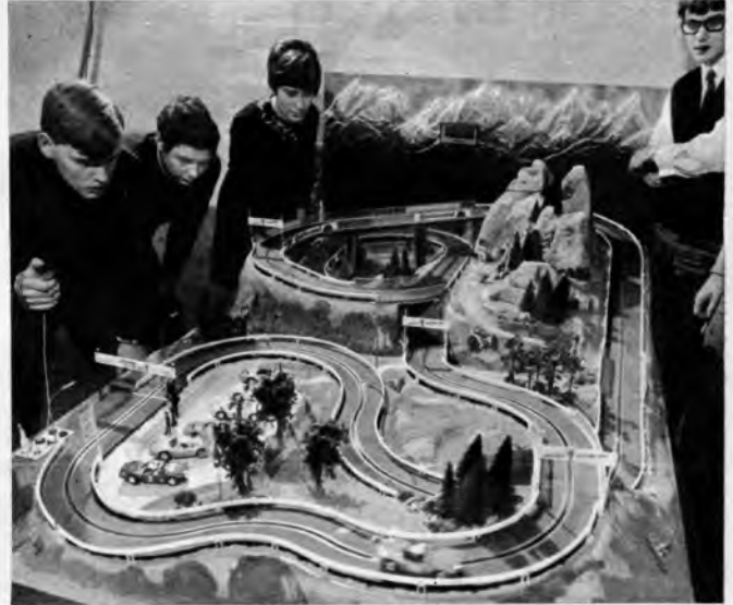
Bild 5. 10,5 m haben die Autos auf dieser Modellstrecke von Stabo zurückzulegen. Der Gag dieser Anlage ist eine elektronische Zeitmessung, die auf \frac{1}{100} s genau arbeitet
