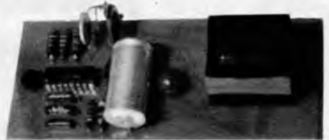
Fertig geschaltetes Netzgerät
