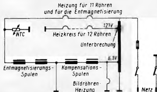
Infolge der gekennzeichneten Unterbrechung am Transformator ergab sich ein zu großer Strom durch die Kompensationsspulen, der zu einer Farbunreinheit führte
