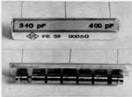
Links: Bild 9. Mechanisches Filter zum Erhöhen der Selektion in Zf-Ver- stärkern, Typ FE 32, für 455 kHz (AEG-Telefunken)
