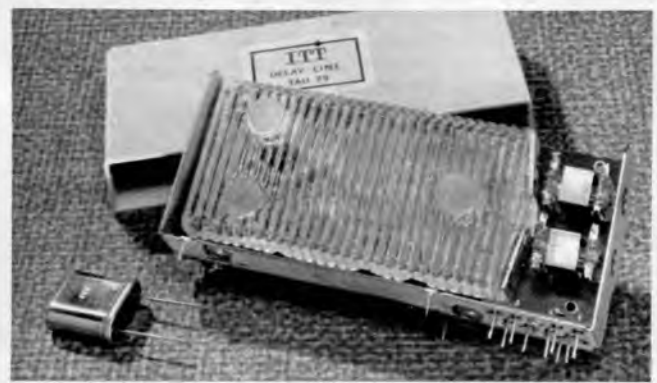
Bild 8. Verzögerungsleitung TAU 20 für Pal-, Secam- und NTSC-Farbempfänger; unten links ein 4,43-MHz-Quarzoszillator für Pal- und NTSC-Empfänger (ITT)
