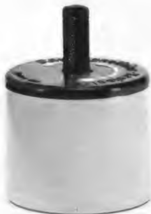
Bild 1. Entmagnetisierungskreisell, wie er heute viel benutzt wird. Bei seiner Handhabung ist Vorsicht geboten; er ruft eine Feldstärke von etwa 1000 Oersted hervor und kann unbeabsichtigt eine wertvolle Aufnahme löschen
