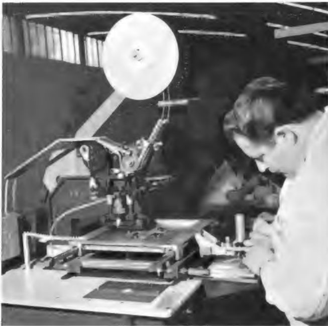
Maschine zum halbautomatischen Bestücken von Platinen. Anhand der Schablone vorn rechts wird die Platine richtig unter den Automaten geführt
