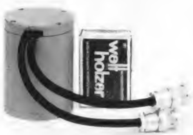
Bild 3. Komplettes UHF-Filter mit Steuermagnet und Hf-Anschlüssen
