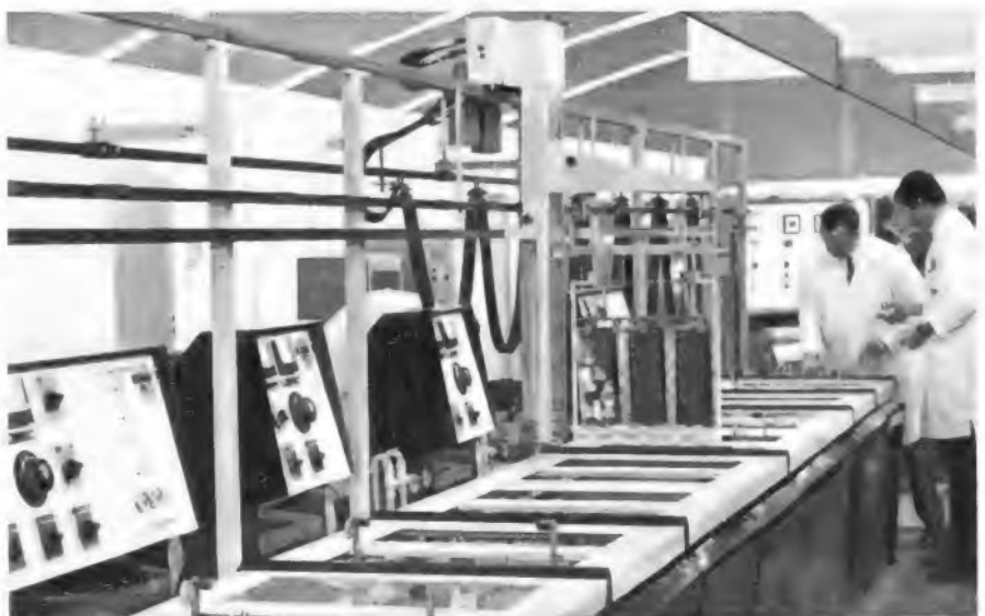
Automatische Straße zur chemischen Behandlung der Platinen, wie Ätzen, Wässern und Schichtentfernen (Aufnahmen (5): C. Stumpf)
