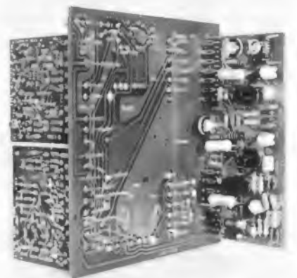
Bild 2. Chrominanzteil wie in Bild 1, jedoch von rückwärts aufgenommen. Eine der fünf Einzelplatten ist für Servicezwecke umgesteckt
