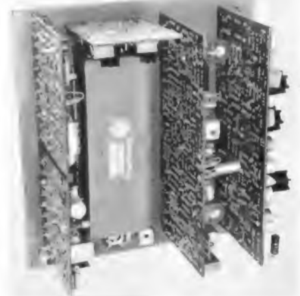
Bild 1. Chrominanzteil des Chassis mit Trägerplatte und Pal-Verzögerungsleitung sowie fünf aufgesteckten Einzelplatten.
