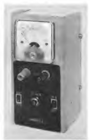
Bild 1. Kapazitätsmeßgerät Capatest I von Radio-Fern. Das Gehäuse ist nur 120 mm hoch bei 60 mm Breite
