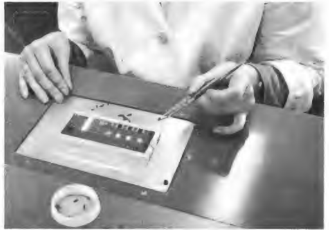
Ausschnitt aus dem Bild links: Gleichzeitig wird die Platine an den Stellen beleuchtet, wo die entsprechenden Bauelemente eingesetzt werden sollen
