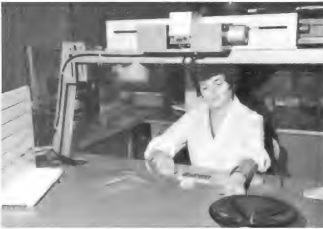
Anlage zum manuellen Bestücken von Platinen. Durch Drehen des Handrades vorn rechts wird ein Kasten mit Bauelementen freigegeben
