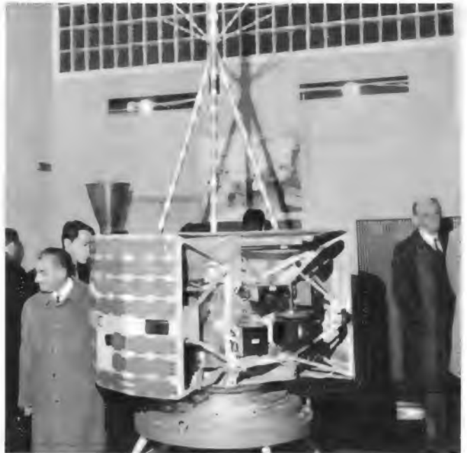
Schnittmodell des Satelliten Heos-A zum Messen der Energieverteilung außerhalb der Erdmagnetosphäre (Sonderschau Mikroelektronik)
