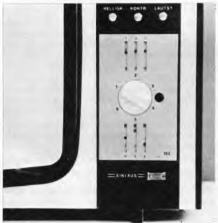
Nach dem Prinzip des auf dem Titelbild dargestellten AM/FM-Abstimmaggregates entwickelte SEL auch eine Ausführung zum Speichern von insgesamt sechs Fernsehprogrammen
