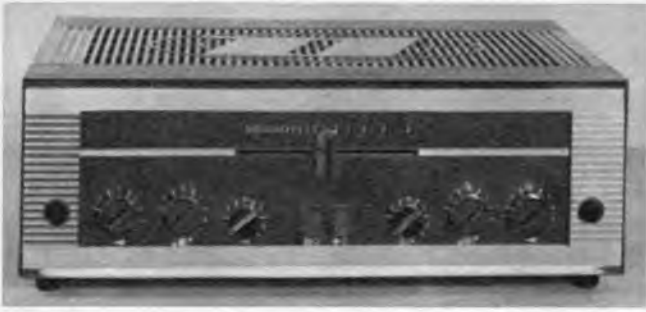
Bild 13. Mit dem mittleren Schieberegler wird beim Echocord Mini (Dynacord) der Sprechkopf längs des Bandes verschoben
