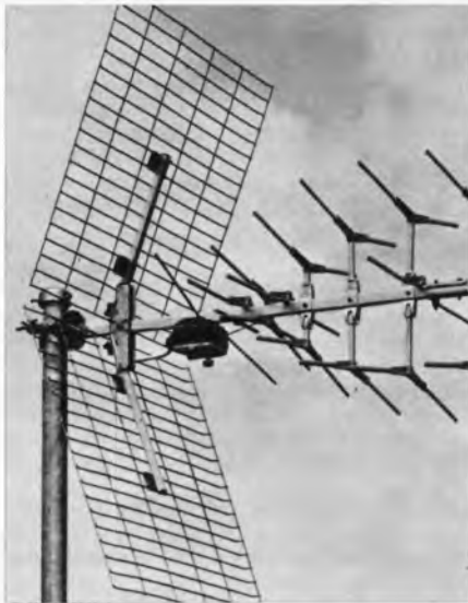
Teilansicht der Antenne Fesa 415 U 60. Um eine richtige Ankopplung der vier Direktorreihen zu erreichen, rücken die letzten Direktoren vor dem Anschlußdipol enger zusammen
