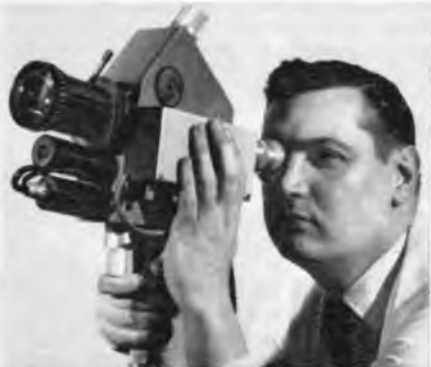
Bild 2. Versuchsausführung einer Miniaturfarbferrisehkamera; sie wiegt mit elektronischem Sucher und Variooptik nur 5 kg
