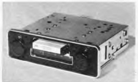
Amerikanischer MW-Autoempfänger mit eingebautem Kassettenspieler, der speziell für den Volkswagen bestimmt ist
