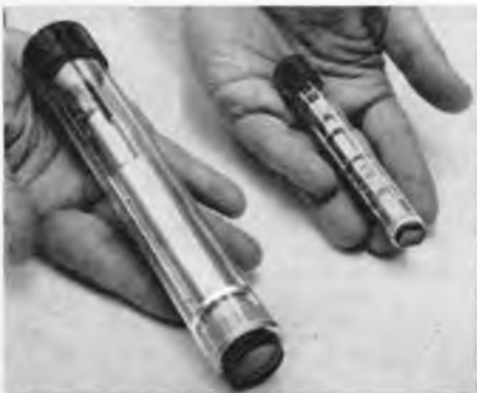
Bild 1. Die neue Miniatur-Plumbicon-Aufnahmeröhre mit nur noch 16 mm Außendurchmesser im Vergleich zum Standard-Plumbicon (links)
