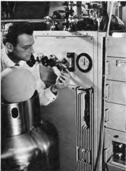
Der parametrische Vorverstärker für Raisting I. Links vorn der Spezialbehälter für das flüssige Helium, mit dem der Verstärker gekühlt wird
