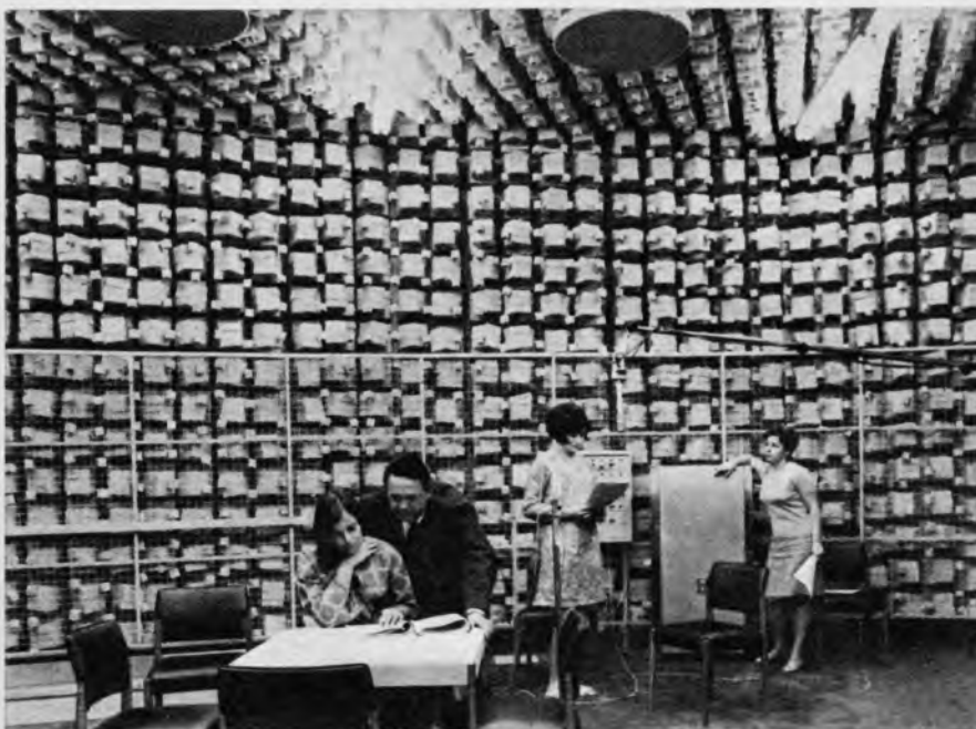
Unten: Bild 2. In diesem schalltoten Raum werden Szenen aufgenommen, die „im Freien“ spielen
