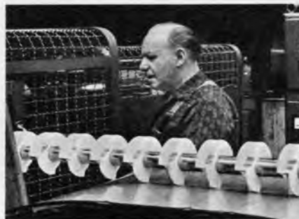
Der Innenleiter für ein Hiflex-Kabel, ein weiches Kupferrohr, verläßt die Spritzgußmaschine, wo die Abstandsscheiben aus Polystyrol aufgebracht wurden
