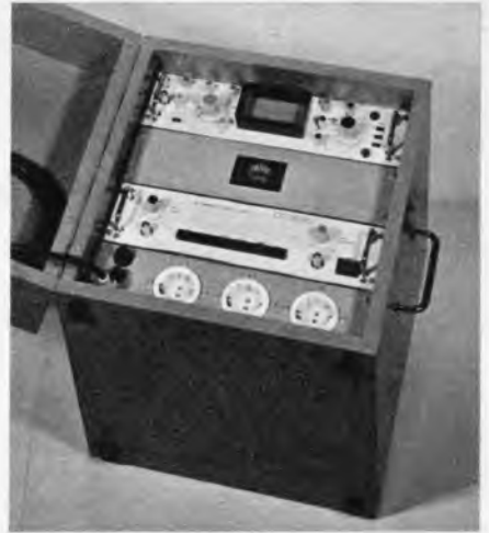
Bild 3. Zum Transport für den Außendienst lassen sich die Meßgeräteeinschübe in einen Spezialkoffer einsetzen. Auch bei Arbeiten beim Kunden gibt es somit keine fliegenden Leitungen und keine unsicheren Mehrfachstecker für die Netzkabel mehr
