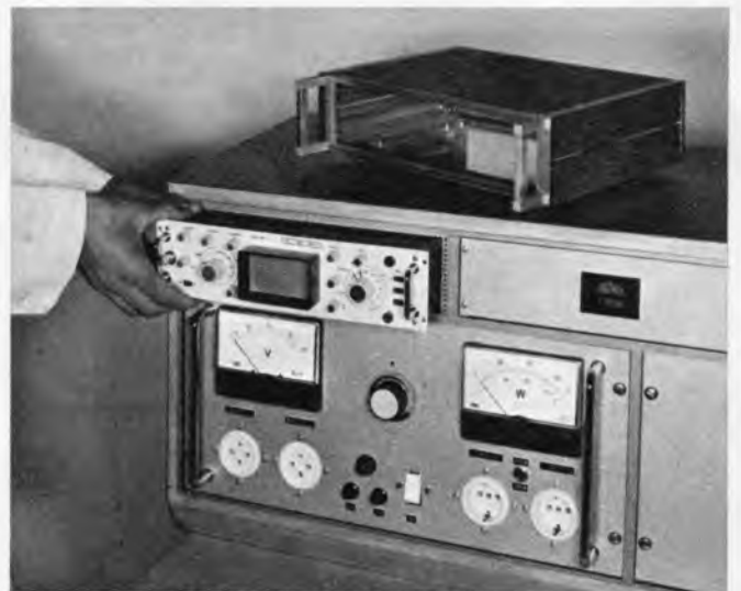
Bild 2. Die Meßgeräte werden nicht mehr aufeinandergestapelt, sondern in das Aufbaugesstell eingeschoben
