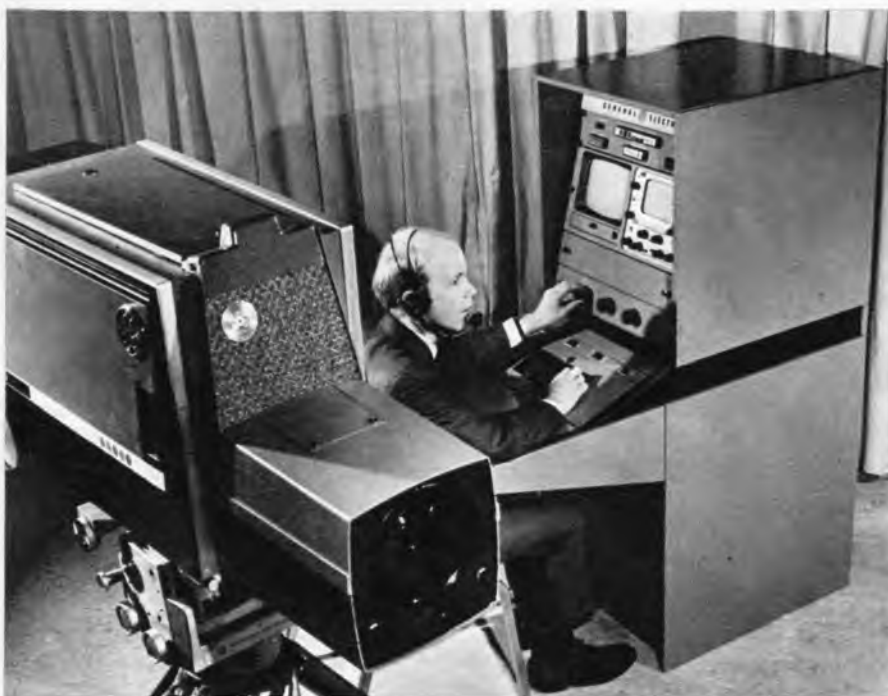
Die neue Vierröhren-Farbfernsehkamera PE-350 mit dem Kamerakontrollgestell PR-300-A von General Electric Co., Syracuse/USA
