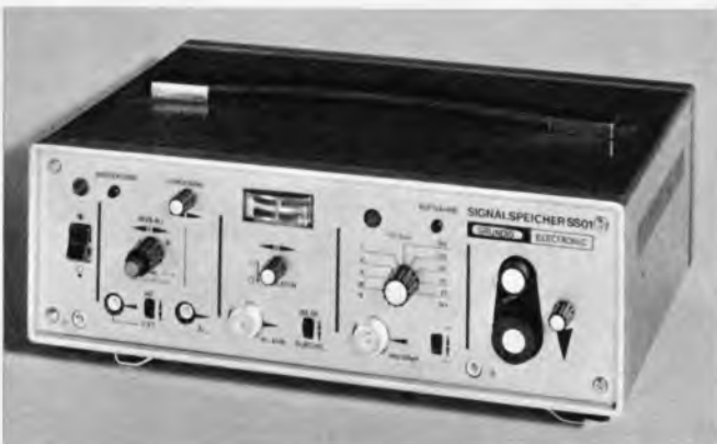
Links: Bild 5. Oszillografen-Signalspeicher für ständige Wiedergabe einmaliger Signale (Grundig)
