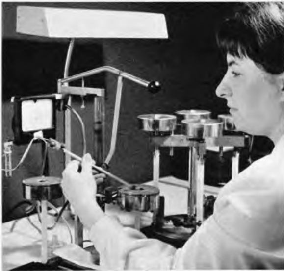
Bild 4. Kontrolle der Stabtemperatur vor dem Auflöten der Wandler
