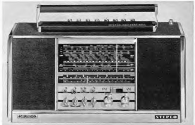
Bild 2. Reiseempfänger für Stereo-Rundfunkempfang: der Stereo-Concert-Boy von Grundig. Die recht schmale Stereobasis kann durch Anschließen eines Zusatzlautsprechers verbreitert werden
