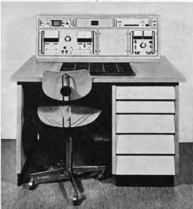
Bild 2. Die Meßgeräte werden nicht mehr aufeinandergestapelt, sondern in das Aufbaugesstell eingeschoben
