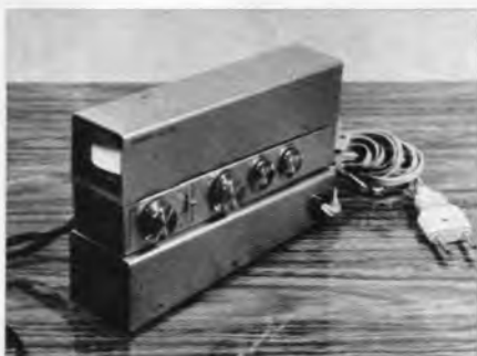
Bild 7. 1-Zoll-Fernsehempfänger von Sony, weitgehend aus integrierten Schaltungen zusammengesetzt. Im ansteckbaren Sockel befindet sich Netz- und Ladeteil für die Miniaturakkumulatoren
