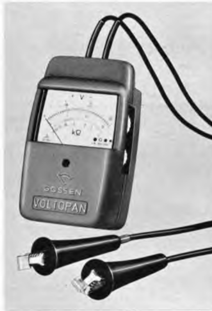
Oben: Bild 1. Voltopan, ein Taschenmeßgerät für den Kfz-Service. Der Widerstandsbereich dient zum Messen von Entstörwiderständen
