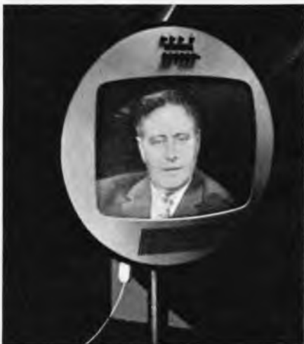
Bild 9. Der Versuch einer neuartigen Formgestaltung: 59-cm-Schwarzweißgerät „Lancet“ von Philips (Aufnahme: E. Schwahn)
