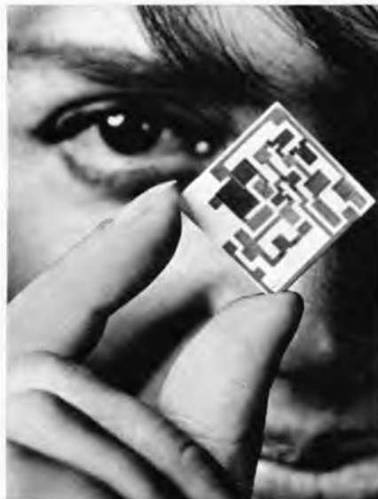
Bild 9. Plättchenförmige elektronische Baugruppe, bei der Widerstände und Leitungen im Druckverfahren hergestellt wurden (Siemens)
