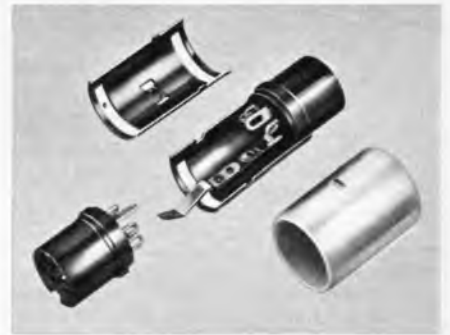
Links: Bild 5. UHF-Tuner zum wahlweisen Einlöten in gedruckte Schaltungen oder für konventionellen Aufbau (Hopt)
