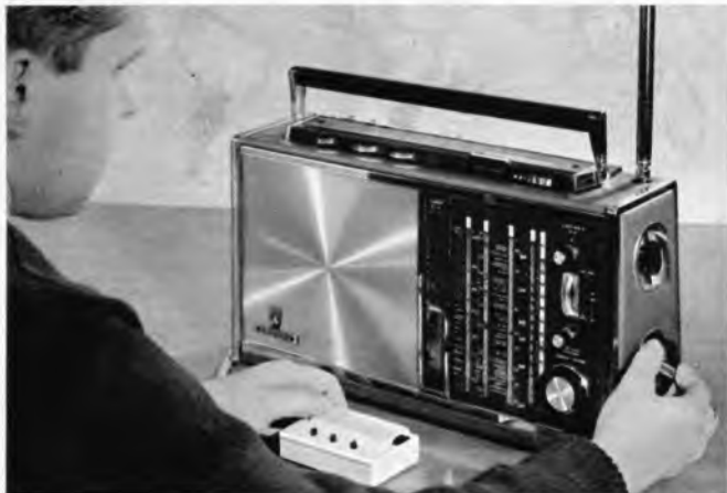
Bild 5. Der Reiseempfänger Satellit von Grundig mit dem zugeschalteten SSB-Zusatz
