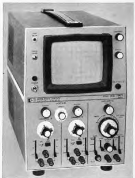
Links: Bild 5. Oszillografen-Signalspeicher für ständige Wiedergabe einmaliger Signale (Grundig)
