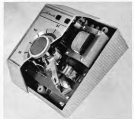
Links: Bild 7. Komplette Sicaset-Antennenverstärker-Station für LMK, UKW und vier Fernsehprogramme (Siemens)
