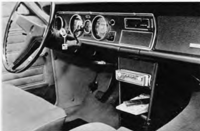
Bild 1. Rallye-Box nennt Akkord seine neue Zusatzeinrichtung, die einer Halterung für einen Reiseempfänger mit besonderem Verstärker und, falls erforderlich, einem Zweitlautsprecher Platz bietet
