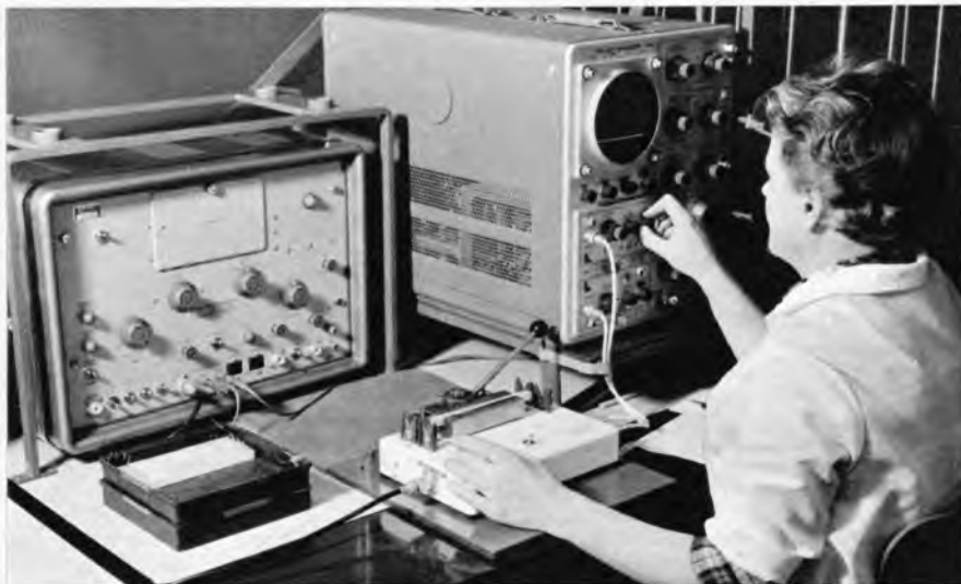
Bild 5. Kontrolle der Durchlaßkurve der nicht umgossenen Verzögerungsleitung
