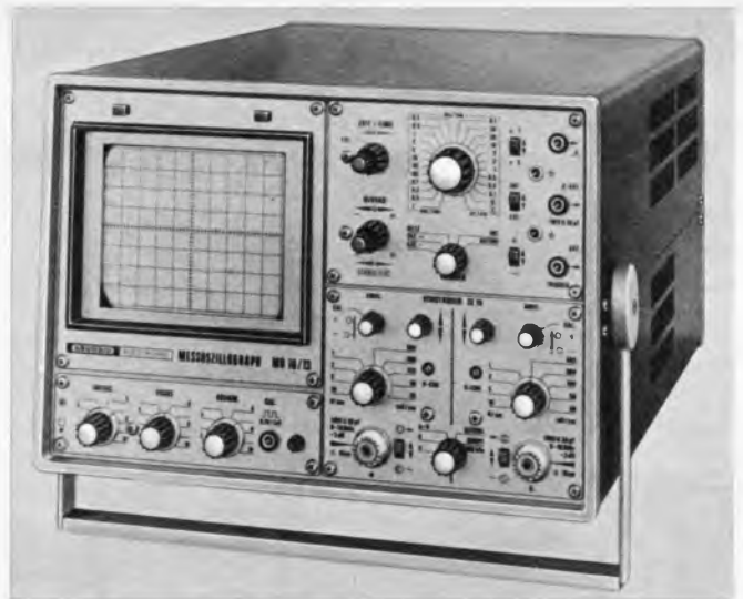
Rechts: Bild 4. Fernseh-Meßoszillograf MO 10/13-TV mit 80 mm × 100 mm großer Leuchtschirmfläche und Verstärkereinschüben (Grundig)
