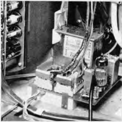
Bild 2. Der diodenabgestimmte Allbereichstuner im Philips-Goyo Luxor befindet sich auf dem „kühlen“ Gehäuseboden, weit entfernt von der Frontplatte. Rechts die 1. Zf-Röhre EF 184. Im Technikerjargon heißt diese Anordnung „die Bohrinse!“ – wegen einer gemissenen optischen Ähnlichkeit mit diesen Bauten auf See
