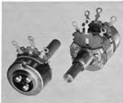
Bild 1. Ein 5-W-Drahtpotentiometer der Serie AW. Links eine Ausführung mit Planetengetriebe (Typ VA-AW); für eine Schleiferbewegung von 1^\circ muß die Achse um 10,5^\circ gedreht werden (CTS-Deutschland)
