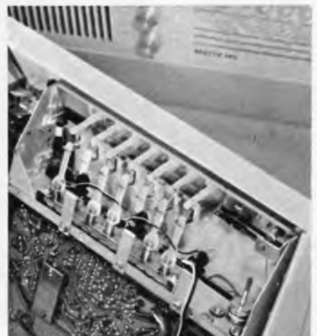
Links: Bild 6. So flach, daß man ihn an die Wand hängen kann, ist der Empfänger RT 265 von Imperial-CE. Zur Senderwahl dient ein walzenförmiger Knopf
