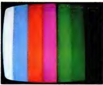
Bild F 72. Farbbild mit komplementär verfälschten Farben einer Treppenbalkenfolge infolge starker Verstimmung des 4,43-MHz-Burstkreises L 309/L 307-L 308 in der 4,43-MHz-Oszillator-Phasenbrücke
