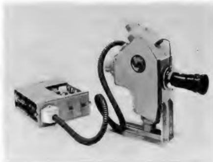
Tragbare Farbfernsehkamera von Philips mit drei Plumbikon-Aufnahmeröhren. Links: der auf dem Rücken zu tragende Verstärker- und Regelteil. Gesamtgewicht: 20 kg
