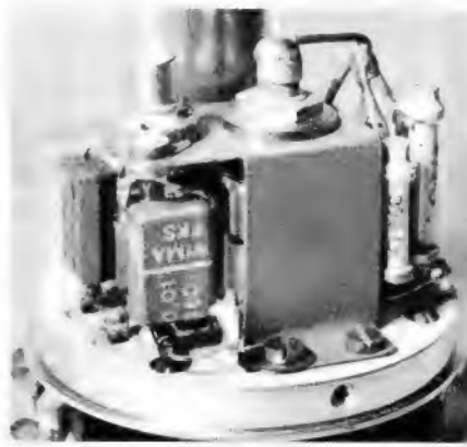
Bild 5. Der mechanische Aufbau des Quarz-oszillators. Im Hintergrund der Metallzylinder des Quarzes
