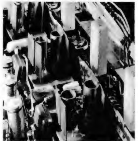
Blick in das Chassis des Präfekt Color 1042. Im Mittelteil 3 \times zwei Transistoren BF 117 mit Kühlschellen für die RGB-Endstufen, rechts davon die Kontaktbahn des Serviceschalters. (Werkaufnahme: Graetz)
