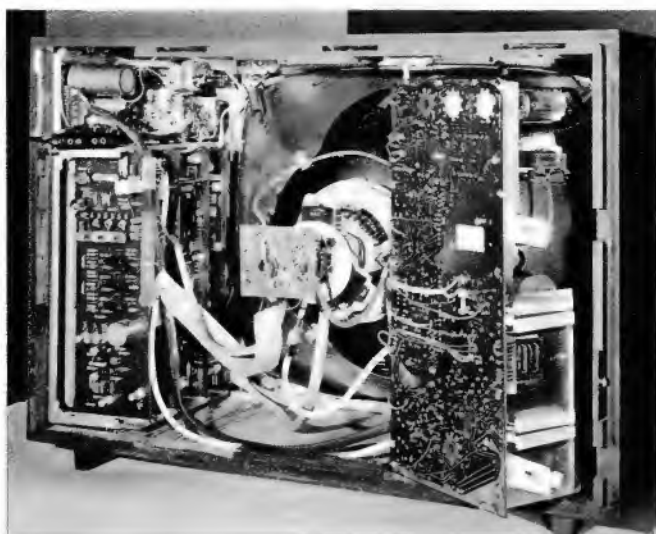
Bild 1. Innenansicht des Farbfernseh-Mehrnormen-Gerätes Barcolor (für Pal- und Secam-System) mit interessanter Platinenbauweise (Aufnahme: N.V. CO. B.A.R.)
