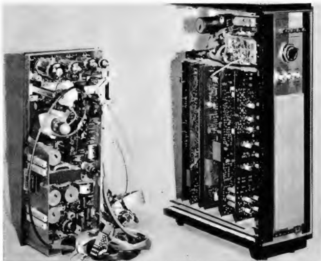
Bild 2. Die Platinen des Barcolor-Mehrnormen-Farbempfängers lassen sich ohne Löten aus dem Chassis ziehen. Links Ablenkteil mit Hochspannungserzeugung, rechts das übrige Chassis (Aufnahme: N.V. CO. B.A.R.)
