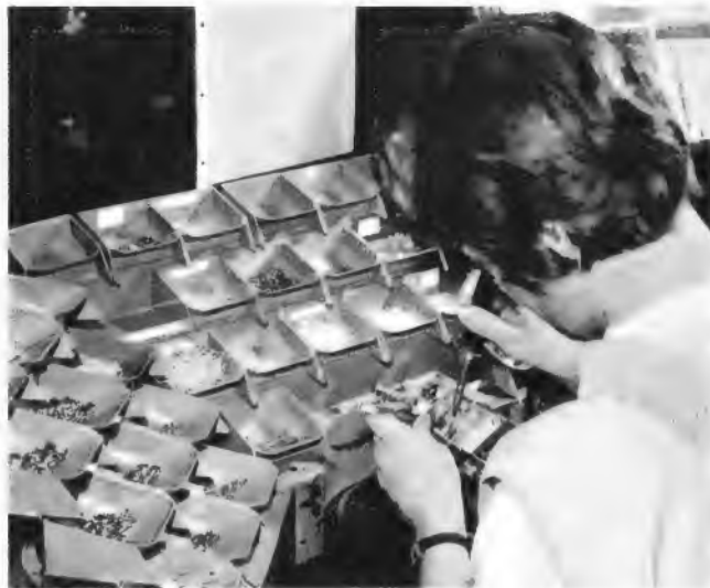
Bild 4. Herstellung von TGA-Einschubverstärkern. Die zu montierenden Teile sind derart angeordnet, daß die Griffzeit auf ein Minimum sinkt
