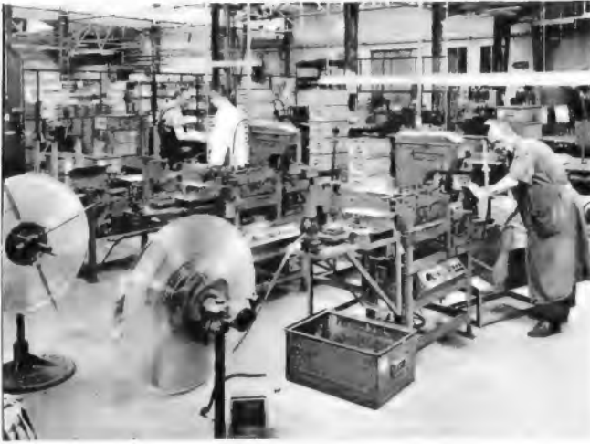
Bild 2. Teilansicht der Antennenorfertigung. Im Vordergrund die Herstellung von Profilelementen für UHF-Antennen aus Bändern. Die Arbeitsgänge sind weitgehend automatisiert; nur noch die Einrichter sind von Fall zu Fall an den Maschinen tätig
