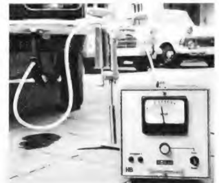
Messen des Kohlenmonoxid-Anteiles in den Auspuffgasen eines Kraftfahrzeuges mit Hilfe des CO-Testers von Hartmann & Braun
