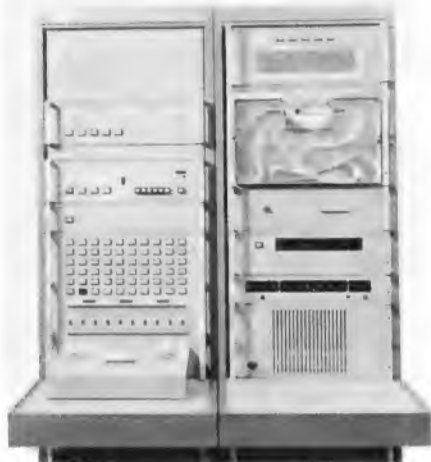
Der erste in Deutschland entwickelte Meßautomat für integrierte Schaltungen. Er prüft bei automatischer Bestückung 1500 bis 2000 Bausteine pro Stunde (Werkaufnahme: Rohde & Schwarz)
