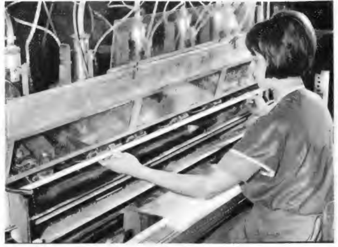
Bild 3. Der Elementträger einer Fernsehantenne wird auf einer selbst entwickelten Vorrichtung an mehreren Stellen gleichzeitig mit Durchbrüchen versehen. Die flexibel gehaltene Vorrichtung vermindert die Umrüstzeit für die verschiedenen Antennentypen beträchtlich
