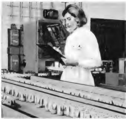
Bild 6. Tausende von Monozellen verlassen stündlich die automatische Fertigungsstraße bei Varta. Die Arbeitskräfte dienen im wesentlichen nur noch zur Überwachung
