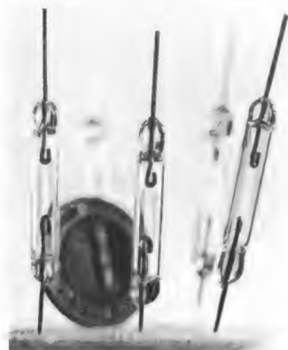
Bild 5. Der gasgefüllte Überspannungsableiter KA 7 von Siemens soll die Farbbildröhre vor Schädigungen durch Hochspannungsüberschläge schützen
