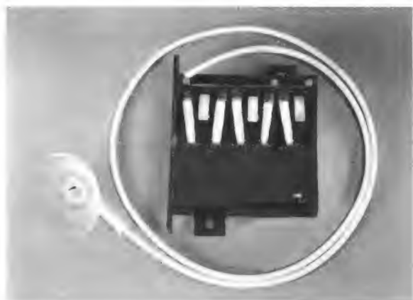
Bild 3. Hochspannungsoerdreifacher mit Selengleichrichtern von SEL für die Anodenspannungsversorgung der Farbbildröhre
