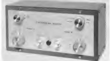
Bild 2. Elektronischer Schalter von Graetz zum gleichzeitigen Schreiben von zwei Oszillogrammen auf einem Einstrahl-Oszillografen
