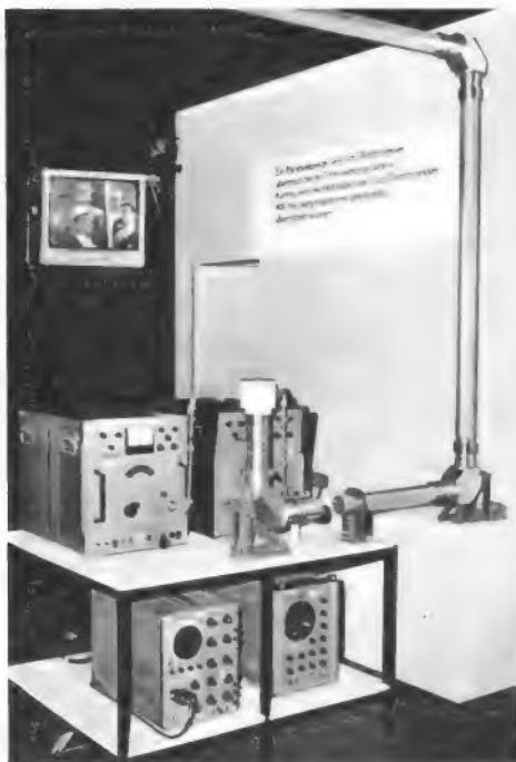
Bild 11. Hohlkabel-Versuchsanlage der Deutschen Bundespost zur Übertragung eines Frequenzspektrums, das 400 Fernsehprogramme enthalten könnte
