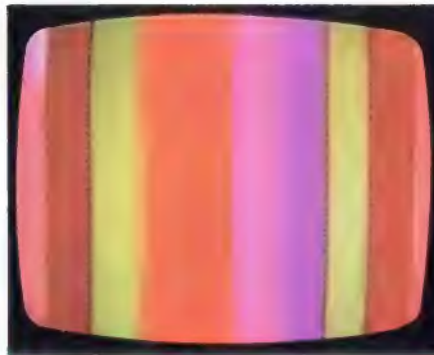
Bild F 44. Phasenbalkentestbild bei Unterbrechung der rechten Klemmdiode in der ( R' - Y' )-Klemmschaltung, Emission des Rot-Systems zu hoch
