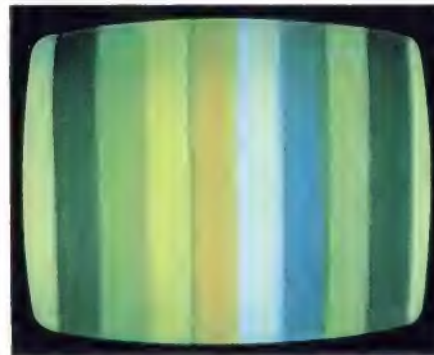
Bild F 47. Phasenbalkentestbild bei Schluß der rechten Klemmdiode, Emission des Grün-Elektronenstrahlensystems zu hoch, auch Leitung zum Grün-System unterbrochen
