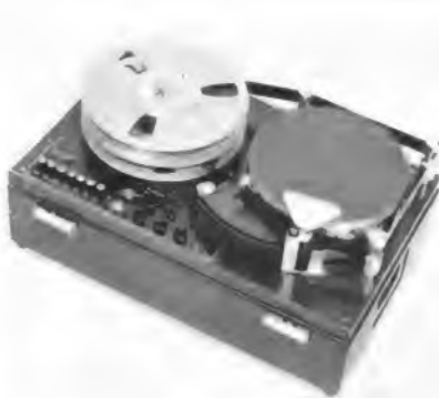
Bild 4. Semi-professioneller Videorecorder BK 200. Zwecks Platzersparnis sind die Spulen übereinander angeordnet (Werkaufnahme: Grundig)
