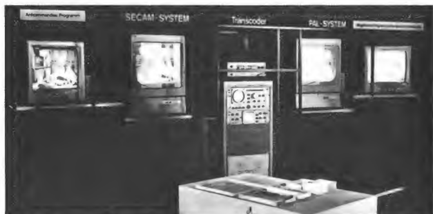
Bild 5. Die Deutsche Bundespost zeigte ihren Transcoder, der bei Eurovisions-Sendungen die Farbfernsehsignale der französischen Secam-Norm in die Pal-Norm umsetzt
