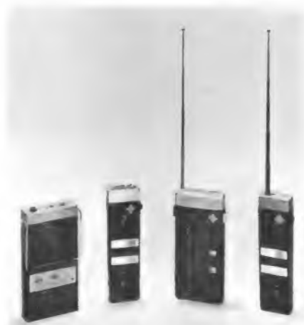
Bild 2. Die vier Grundtypen der tragbaren Geräte. Von links: UKW-Empfänger D 650, UKW-Empfänger D 651, UKW-Sende-Empfänger D 658, UKW-Rücksprechsender D 680 (Werkaufnahme: AEG-Telefunken)
