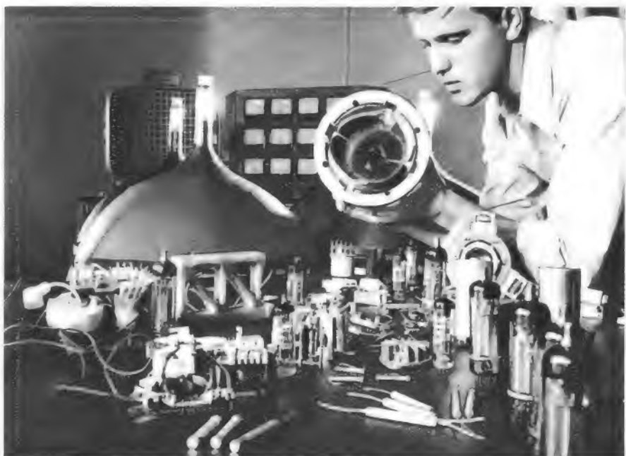
Bild 1. „Bunt“ ist auch das Innenleben eines Farbfernsehgerätes: Erkennbar sind die verschiedensten Bauelemente vom Rohrkondensator über die Vervielfacherkaskade bis zur Farbbildröhre (Werkaufnahme: Siemens)
