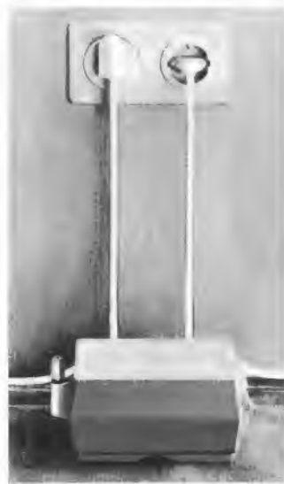
Bild 5. Zweitgeräteverteiler mit einem Transistorverstärker zum Anschluß von zwei Empfängern an eine Antennensteckdose (Siemens)
