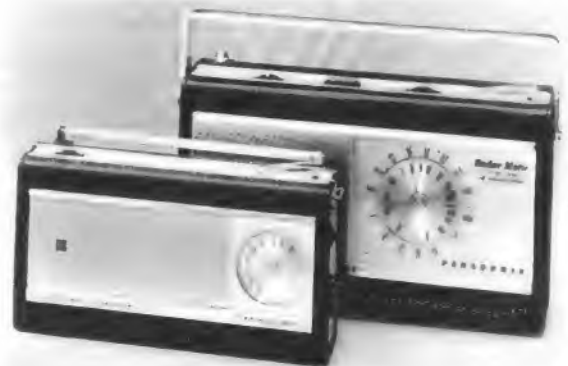
Bild 1. Reiseempfänger vom Typ Radar Matic mit automatischem Sendersuchlauf. Das Modell RF 1000 (links) ist ein FM-Empfänger für den Bereich 87...108 MHz, der Typ RF 2000 besitzt UKW- und MW-Bereich. Beim Antippen der Tasten, rechts oben auf den Gehäusen, dreht sich die Frequenzskala selbsttätig und setzt sich bei Empfang eines Senders still (Aufnahmen Bild 1 und 5: D. Limann)
