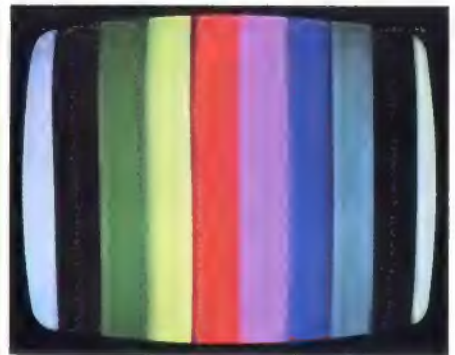
Bild F 45. Phasenbalkentestbild, wenn der 56-k \Omega -Matrix-Widerstand R 425 in der ( G' - Y' )-Dematrix unterbrochen ist
