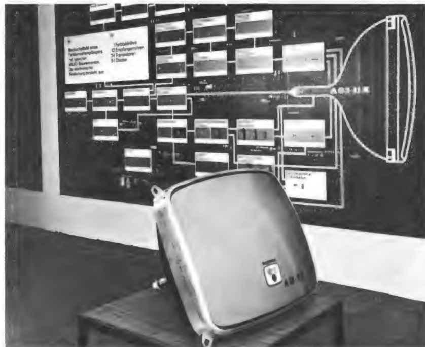
Bild 12. Schaubild mit der Blockschaltung eines Farbfernsehempfängers und den typischen Bauelementen am Valco-Stand: eine Bildröhre, zwölf Röhren, 34 Transistoren und 51 Dioden Bilder 2, 3, 5 bis 12; Aufnahme: E. Schwahn
