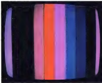
Bild F 46. Phasenbalkentestbild bei Ausfall des ( G' - Y' )-Farbdifferenzsignal-Verstärkers, auch Schluß bzw. Unterbrechung der linken Klemmdiode in der ( G' - Y' )-Klemmschaltung
