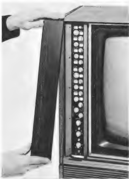
Bild 4a. Die „Batterie“ der Konvergenzeinsteller ist am Beovision 3000 Colour links neben dem 63-cm-Bildschirm unter einer Klappe oberogen (Aufnahme: Bang & Olufsen)
