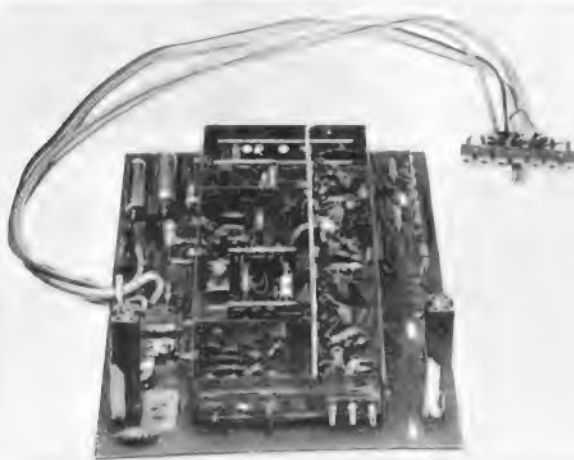
Bild 5. Der auf einer Druckplatine aufgebaute Allbereichstuner MT 500 mit Diodenabstimmung und Dioden-Bereichsumschaltung (Aufnahme: AEG-Telefunken)
