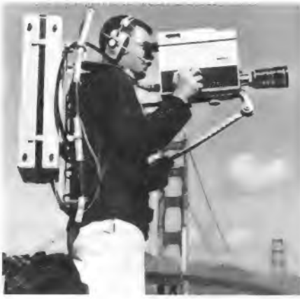
Bild 3. VR-3000, ein tragbarer Videorecorder für Reportagen mit nur 23 kg Gewicht einschließlich Kamera. Er liefert Bänder zum sofortigen Abspielen auf den üblichen Studioanlagen wie VR-2000 (Werkaufnahme: Ampex Corporation)
