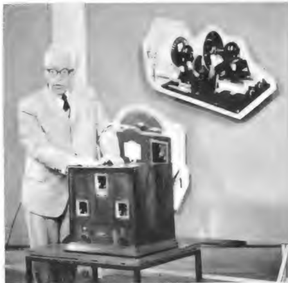
G. Goebel führt in der Sendung „Meilenstein Farbfernsehen“ einen von Tekade gebauten Telehor-Fernsehempfänger mit Nipkowscheibe aus dem Jahr 1930 vor. Zu dieser Zeit wurden Bilder mit 1600 Bildpunkten, 12,5 Bildwechsel pro Sekunde und einem Format von 4 cm × 4 cm erzeugt
