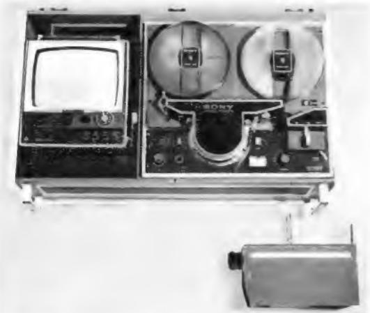
Videoaufzeichnungsanlage CV2000 von Sony. Der Fernsehempfänger ist im linken Fach so angeordnet, daß er zum Betrieb leicht hochgeklappt und auch als Zweitempfänger einfach herausgenommen werden kann. Für die Vidikonkamera wird eine minimale Beleuchtung von 100 Lux angegeben. Die Anlage arbeitet nach der 525-Zeilen-Norm
