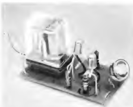
Bild 3. Das zusammengebaute Fotorelais; rechts der Fotowiderstand, er kann über Leitungen an anderer Stelle angeordnet werden
