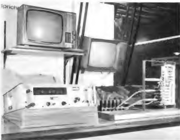
Bild 1. Dauerprüfung eines Fernsehgeräte-Abstimmaggregats von Telefunken. Das Zählwerk zeigt die Anzahl der bisher getätigten Umschaltungen (Aufnahme: Schwahn)
