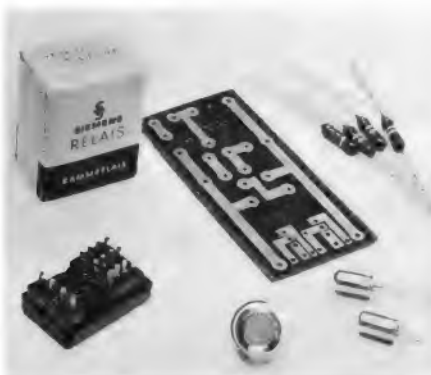
Bild 2. Einzelteile eines Bausatzes für das Fotorelais nach Bild 1 (Radio-Fern)
