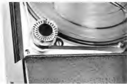
Bild 3. Rolle mit Stroboskopteilung zur Kontrolle der Bandgeschwindigkeit (innere Teilung für 60 Hz, äußere für 50 Hz)
