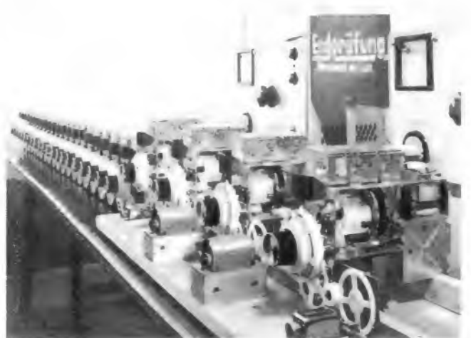
Bild 2. Bei der Fertigungsendprüfung im Grundig-Werk wird eine Dauerprüfung des motorisch angetriebenen Abstimmaggregats Monomat de luxe vorgenommen
