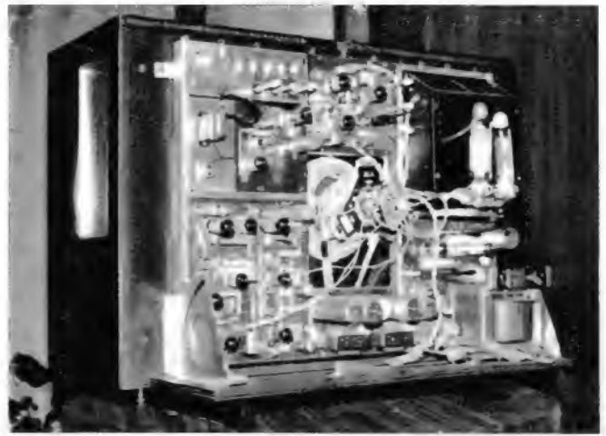
Blick auf das Chassis des Secam-Farbfernsehempfängers RS 16, der im französischen Pavillon auf der Deutschen Industrieausstellung in Berlin gezeigt wurde
