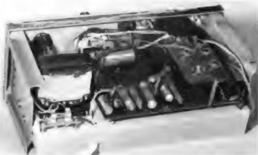
Rechts: Bild 4. Innenansicht des Mustergerätes. Die Schaltung wurde auf Veroboardplatten aufgebaut
