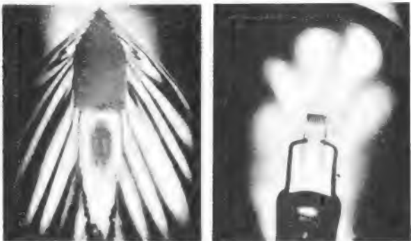
Hologramme von den Stoßwellen eines Geschosses (links) und von den sich überlagernden Wellen heißen Gases im Innern der Lampe eines Autoscheinwerfers unmittelbar nach dem Einschalten (rechts)
