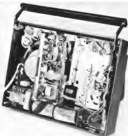
Bild 2a. Innenansicht des Tonbandgerätes mit hochgeklappter Druckschaltplatte
