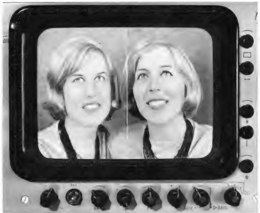
Beispiel zur Schärfverbesserung von Fernsehbildern durch zweidimensionale Aperturkorrektur, die die Unschärfbeeinflüsse bei der Bildsignalerzeugung in Kameraaufnahmeröhren ausgleicht. Das Bild ist mit einem Superikonoskop aufgenommen und durch einen elektronischen Schnitt in zwei Teilbilder aufgespalten. Die hellgestastete Linie markiert die Schnittstelle zwischen den beiden Bildhälften. Die linke Bildhälfte stellt die normale Wiedergabe unter günstigsten Bedingungen dar, rechts ist das Bildsignal nachträglich korrigiert, so daß die Bildschärfe in allseitiger Richtung verbessert ist. Man erkennt dies besonders in den Augenpartien und an dem Haar in der Trennzone zwischen beiden Bildhälften.
