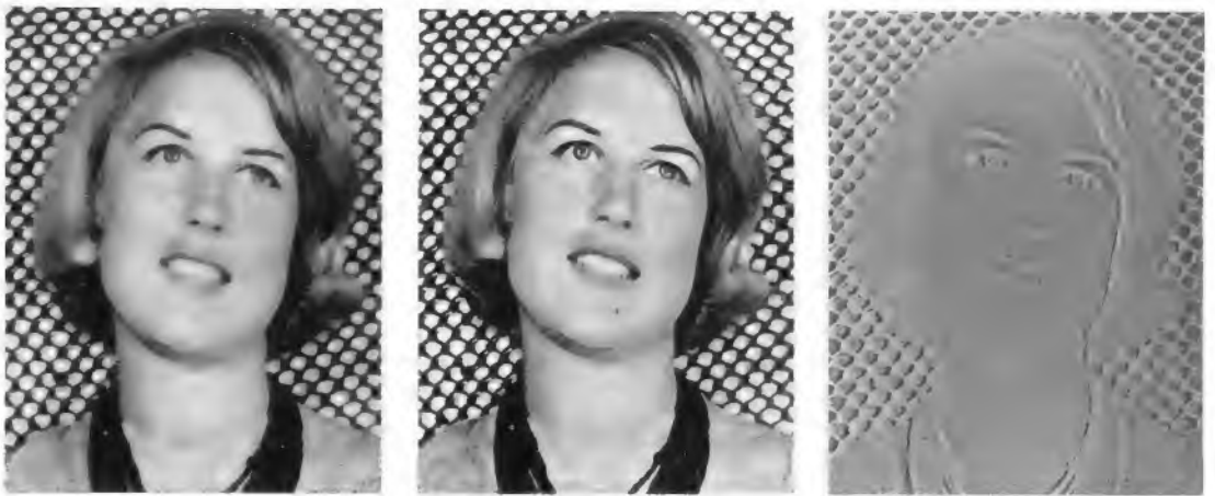
Bild 5. Ausschnitte aus Bildschirmfotos: mit normaler Wiedergabe, also ohne Aperturkorrektur (links), mit Aperturkorrektur und deutlich erkennbarer Schärfverbesserung (Mitte). Rechts: Wiedergabe des Differenzbildes (DBA)
