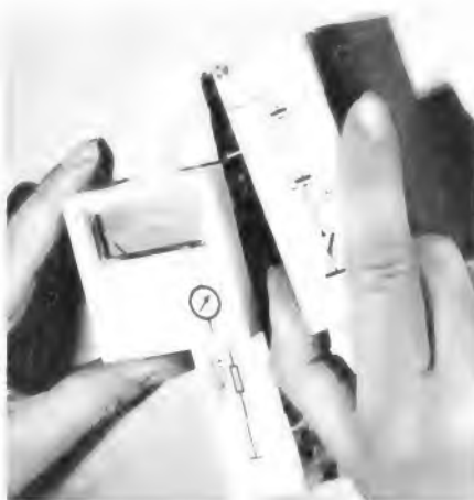
Die Bausteine des Lectron-Systems werden einfach aneinandergereiht. Magnete halten sie zusammen und geben den Druck für die elektrischen Kontakte (Egger-Bahn GmbH, München 25)
