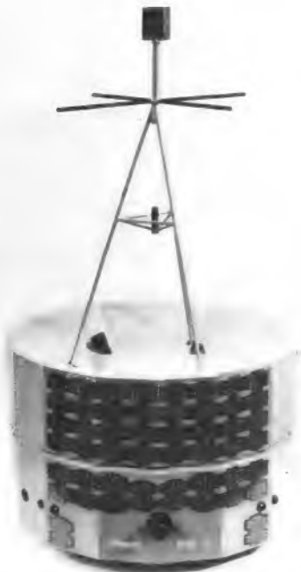
Heos A, ein Spezialmeßsatellit der Junkers Flugzeug- und Motorenwerke AG im Auftrag der Esro. Ganz oben das etwa 2 m entfernt vom Satellitenkörper angebrachte Magnetometer, darunter Kreuzdipol-Antenne mit annähernd Kugelcharakteristik
