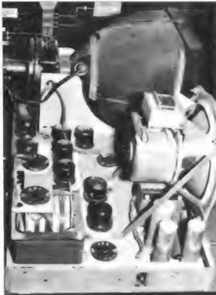
Bild 3. 1939 sollte der reichsdeutsche Fernseh-rundfunk mit 441 Zeilen beginnen. Zu diesem Zweck entwickelte die deutsche Industrie den Einheitsempfänger, Typ E 1. Ein Blick auf das Chassis zeigt die Bestückung mit Stahlröhren und die technisch bemerkenswerte Rechteck-Bildröhre mit einem flachen Bildfeld von 19,5 cm x 22,5 cm. Sie war 384 mm lang und für magnetische Fokussierung und magnetische Ablenkung ausgelegt (Hochspannung 6 kV) (Aufnahme: Dennewitz)
