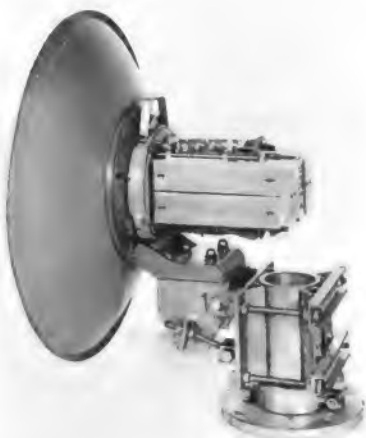
Bild 1. Das Sende-Empfangsgerät ist bei der Normalausführung direkt mit dem Antennenspiegel (70 cm Durchmesser) zusammengebaut. Durch Lösen von drei Schrauben kann das Gerät leicht vom Spiegel abgenommen werden
