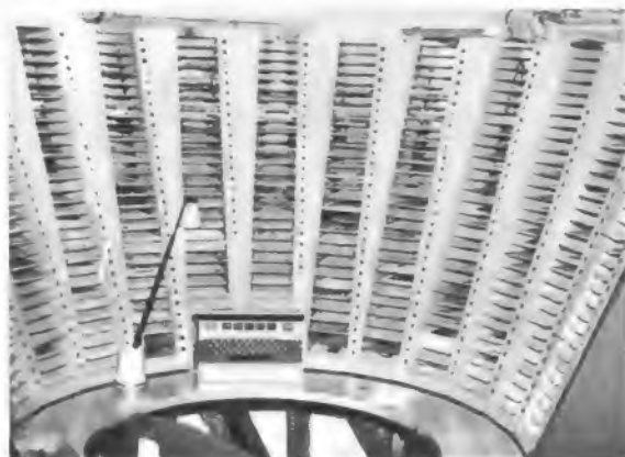
Links: Bild 3. Einschub mit dem Relaiseteil der Prefixauswertung
