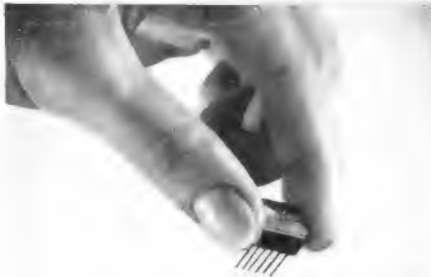
Bild 1. Eine der neuen digitalen Hybridschaltungen von Ferranti mit einer Taktfrequenz bis zu 5 MHz
