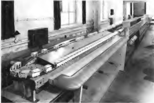
Rechnergesteuerte CAT-Prüfmaschine für die Prüfung und Klassierung von 9000 Transistoren in der Stunde; im Vordergrund die keramischen Transistor-Träger (Texas Instruments)
