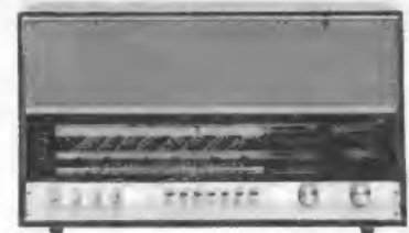
Bild 2. Stereoempfänger Lido von Kuba/Imperial mit zwei eingebauten Lautsprechern, die sich beim Anschließen von Außenlautsprechern abschalten
