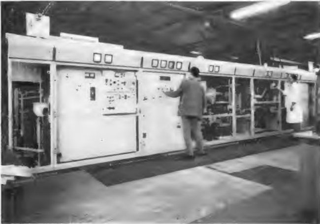
Die neue Langenberger Mittelwellenanlage auf 1586 kHz wird im kommenden Frühjahr fertig sein und dann aus zwei parallel arbeitenden Sendern mit je 400 kW Leistung bestehen, die jedoch bis 600 kW ausgefahren werden können. Unser Bild: einer der Sender im Berliner Telefunken-Prüffeld
