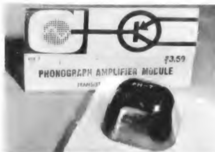
Bild 1. Kompletter Phonoverstärkermodul mit 2 W Ausgangsleistung für Kristalltonabnehmer
