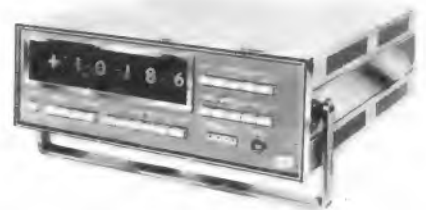
Bild 2. Das integrierende Digitalvoltmeter von Fenlow Electronics erreicht eine Gleichstromunterdrückung von 150 dB. Der Meßbereich reicht von 10 \mu V bis 1000 V
