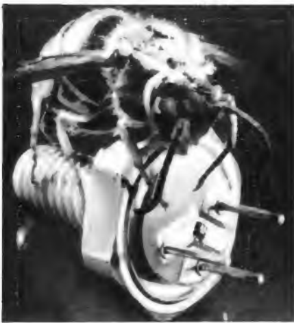
Bild 4. Hochfrequenz-Leistungstransistor BLY 22 von Siemens. Das Transistorsystem liegt zwischen den drei Anschlußstiften
