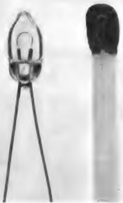
Bild 1. Subminiatur-Glühlampe für optoelektronische Anordnungen (Philips)
