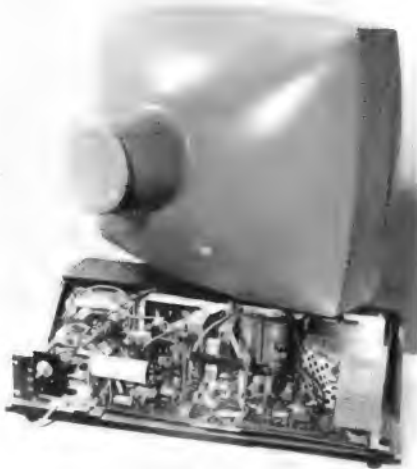
Bild 1. Das freigelegte Chassis im Sockel des Wega-Fernsehempfängers 3000 L. In der großen Plastikhülle befindet sich die 59-cm-Bildröhre; sie ist um 60° schwenkbar
