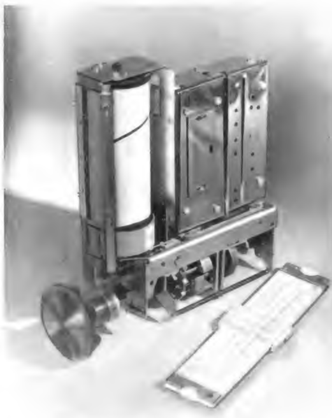
Abstimmkombination Typ 150 mit Allbereich-Abstimmteil für Fernsehempfänger von Telefunken
