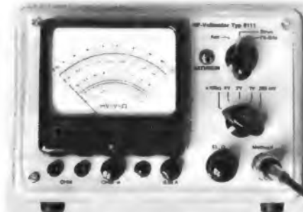
Bild 4. Hf-Voltmeter für Antennenmessungen (Kathrein)
