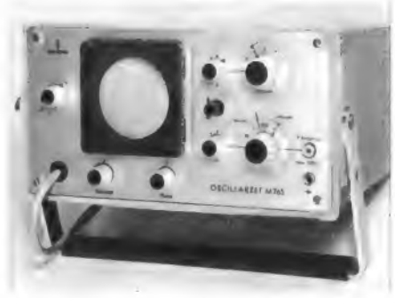
Bild 7. Oscillarzet M 765, ein kleines hochempfindliches Oszilloskop für den Tonfrequenzbereich von Siemens
