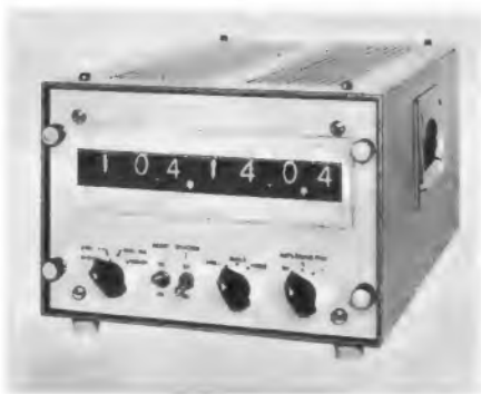
Bild 12. Der Telefunken-Frequenzanzeiger FA 990 arbeitet als elektronischer Zähler. Die Komma-stelle wird automatisch angezeigt
