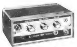
Transistor-Verstärker von 8-30 W
