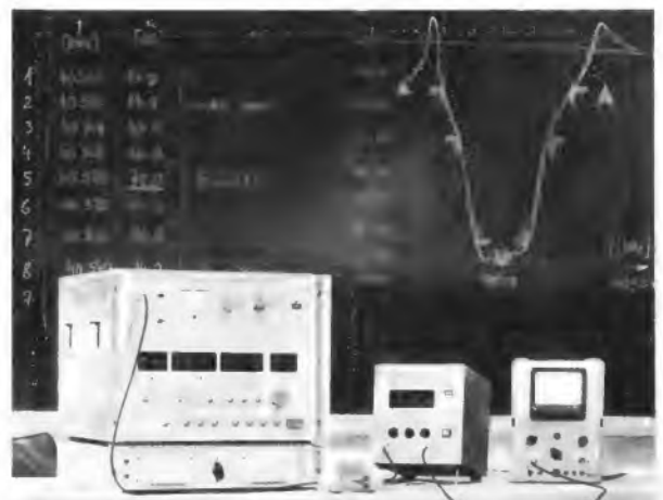
Bild 11. Meßplatz mit dem dekadischen Hf-Meßsender SMDH von Rohde & Schwarz
