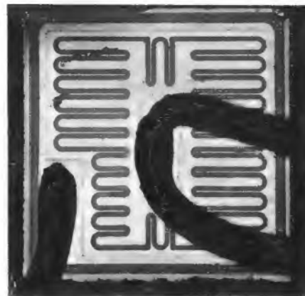
Bild 3. Geometrie des Planar-Epitaxial-Transistors 2 N 3920 von Fairchild
