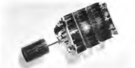
Bild 4. Mehrebenen-Kleindrehschalter für Druckschaltungen (SEL)
