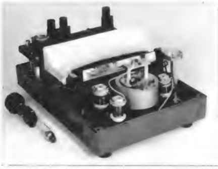
Bild 5. Drehspul-Lichtmarkeninstrument mit Doppelskala von Siemens. Das Gehäuseoberteil ist abgenommen, links liegt die Beleuchtungseinrichtung
