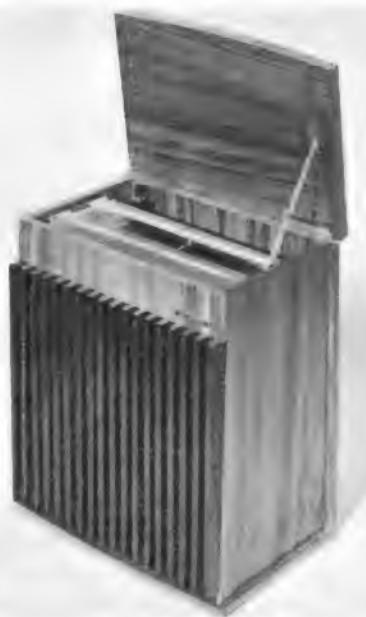
Bild 18. Box-Lautsprecher mit eingebautem Nachhallsystem
