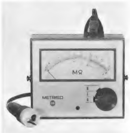
Bild 13. Der Isolationsmesser Metriso von Metrawatt arbeitet mit 600 V Meßgleichspannung, die von einem Gleichspannungswandler erzeugt wird
