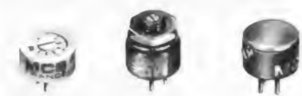
Bild 2. Miniatur-Trimmpotentiometer mit nur 12 mm Gehäusedurchmesser, in der Mitte für Einlochmontage, links und rechts zum Einlöten in Druckschaltungen (TWK-Elektronik)
