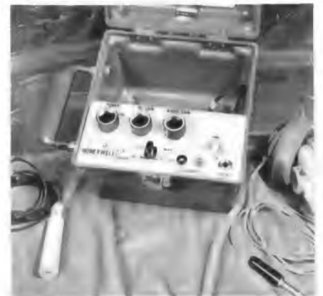
Bild 3. Die Hf-Sonde zum Aufspüren von Wackelkontakten besteht aus der Suchspule, dem Hf-Verstärker mit Detektor und Nf-Teil, aufladbaren Batterien, Kontroll- und Anzeigetafel sowie einem Kopfhörer (Honeywell)
