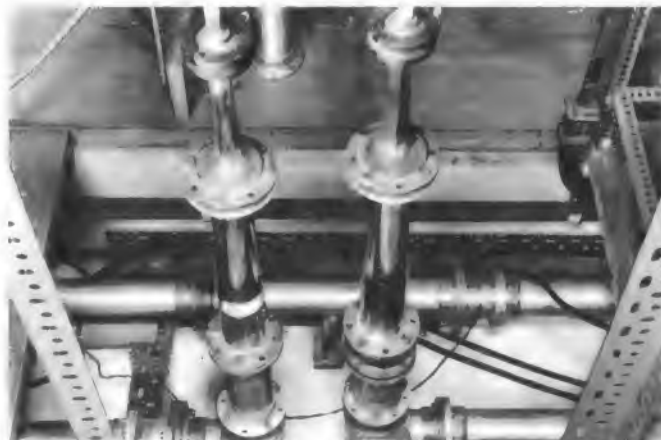
Bild 12. Teilabschnitt einer Hohlkabelleitung mit den Übergängen zu den Sende- und Empfangsgeräten. Die Hohlkabel sind unter dem Fußboden eines Mikromellenlaboratoriums verlegt
