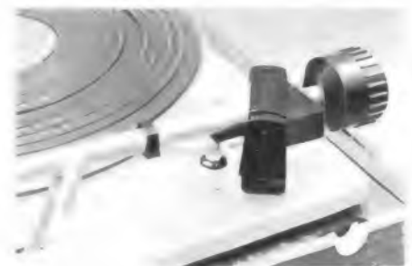
Bild 5. Die Tonarmlagerung mit dem Gegengewicht und der Skala zum Einstellen der Auflagekraft
