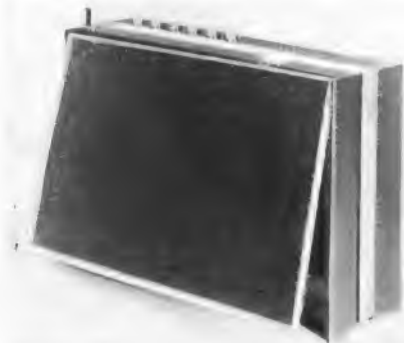
Transita-Solar nennt Nordmende ein Mustergerät, das als Stromversorgung 48 Solarzellen enthält, die in der Rückwand des Empfängers angeordnet sind
