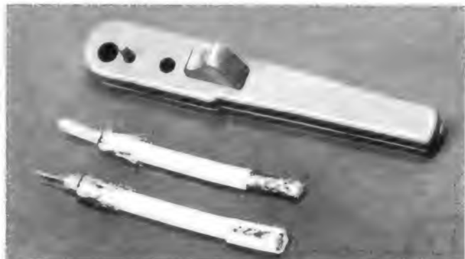
Ein Anschlag des Abisolierwerkzeuges verhindert ein zu tiefes Eindringen in den Mantel eines 60-Ω-Kabels; dadurch wird eine Beschädigung der Abschirmung vermieden
