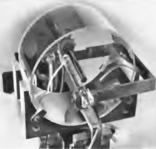
Bild 19. Laserapparatur mit gläsernem Laserstab und elliptischen Spiegeln (Firma Jenaer Glas)
