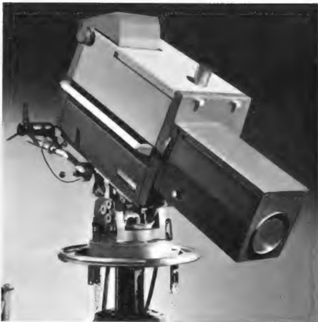
Bild 3. Farbfernsehkamera Mark VII von Marconi mit vier Plumbikonröhren
