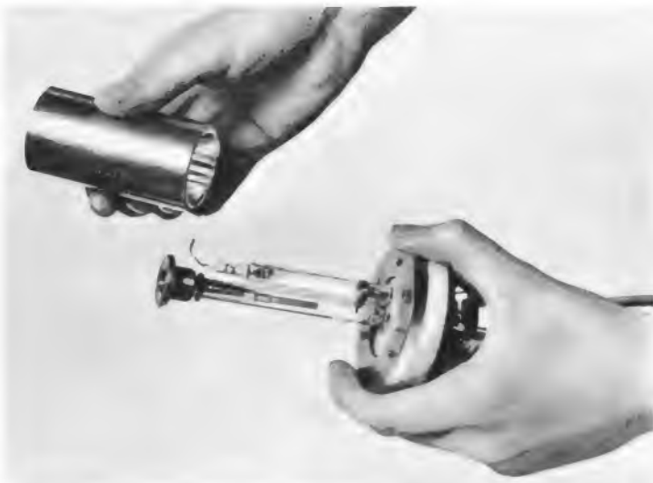
Bild 17. Laseranordnung bestehend aus der stabförmigen Xenon-Blitzröhre 126159 mit parallel liegendem Rubinstab in einem Spezialhalter. Der zylindrische Reflektor wurde abgenommen (Philips)
