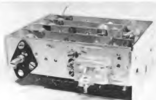
Bild 10. Blick auf die Bedienungssseite. Links: Achse des Vierfach-Drehkondensators, rechts: Schiebeschalter
