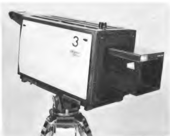
Bild 1. Farbfernsehkamera KC 33 OK 9 A der Fernseh GmbH mit drei 3-Zoll-Image-Orthikon-Röhren und Vario-Optik Varotol V mit Range-Extender und Servosteuerung
