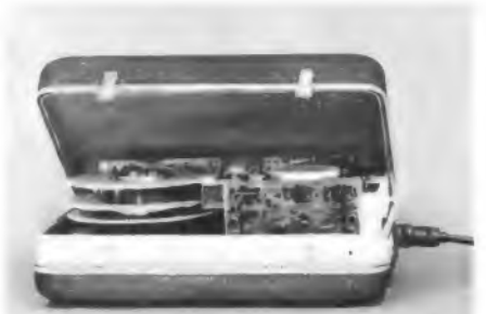
Bild 2. Blick in das geöffnete Aufzeichnungsgerät. Die beiden Bandspulen sind übereinander angeordnet. Das Gerät wiegt komplett etwa 10 kg
