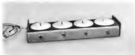
Netzanschlußdose für Versuchsarbeiten. Jede Steckdose kann mit Hilfe eines zweipoligen Kippschalters stromlos gemacht werden
