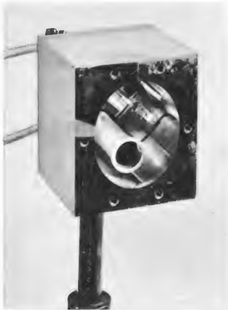
Links: Bild 23. Gehäuseblock des Rubinlasers mit elliptischem Reflektor nach Bild 22. Im oberen Brennpunkt befindet sich die Impulsröhre, im unteren Brennpunkt ist ein Schutzrohr aus Metall zu erkennen. Dieses Schutzrohr wird nach hinten herausgezogen, sobald die Pumplichtlampe gezündet hat
