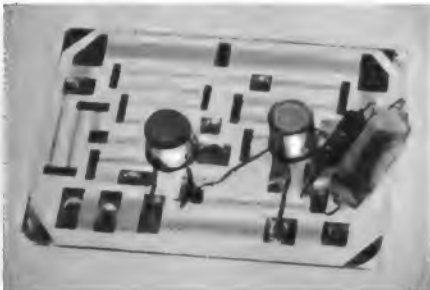
Bild 4. Über 80 Dünnfilmschaltkreise sind in der Mark VII enthalten. Im Bild ein Teil eines der Videoverstärker. Die Trägerplatte ist aus Glas, die Nickel-Chrom-Widerstände sind direkt auf das Glas aufgebracht. An Goldkontakte werden die diskreten Bauelemente (Tantal-Kondensatoren und Transistoren) angelötet
