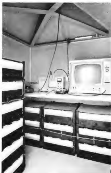
Bild 2. Blick in die Gerätekabine. Links und unten Brennstoffzellen, auf dem Tisch ein transistorbestückter Frequenzumsetzer, daneben ein Meßempfänger
