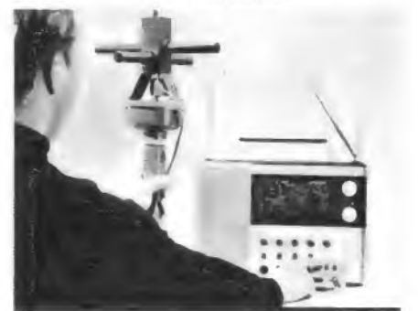
Bild 3. Peiladapter und Peilkreuz für den Braun-Allwellen-Empfänger T 1000
