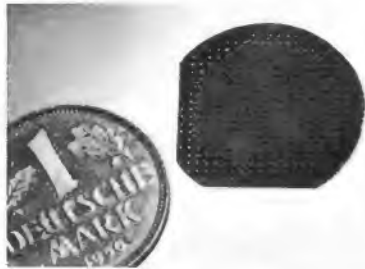
Bild 19.6. Platte mit 400 fartig bedampften Mesa-Transistoren vor dem Zerteilen im Vergleich zu einem Markstück
