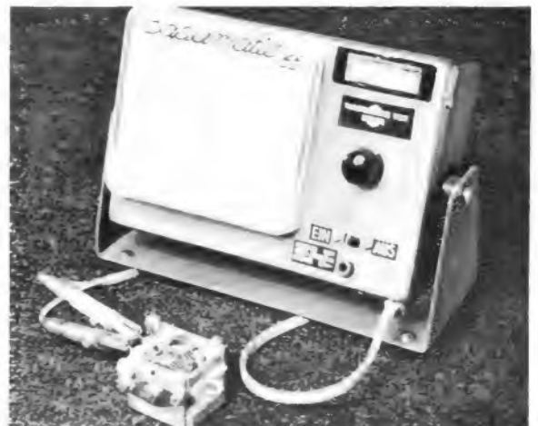
Rechts: Bild 3. Ansicht des Mustergerätes mit stetig einstellbarer Diodenvorspannung und automatischer Bereichsumschaltung
