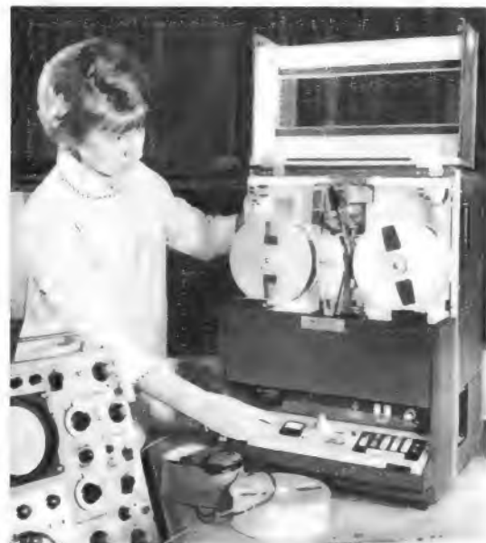
Links: Für Farbfrogrammaufzeichnung erweiterter Videorecorder PU-120 UE von Sony im Laboratorium der CFT. Paris. Das Gerät kostet etwa 40 000 DM
