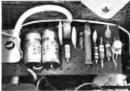
Bild 13. Die Oszillatorplatte von der Bestückungsseite
