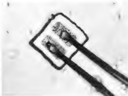
Bild 19.7. Vergrößerte Ansicht eines einzelnen Mesa-Transistors mit angebrachten Zuleitungen
