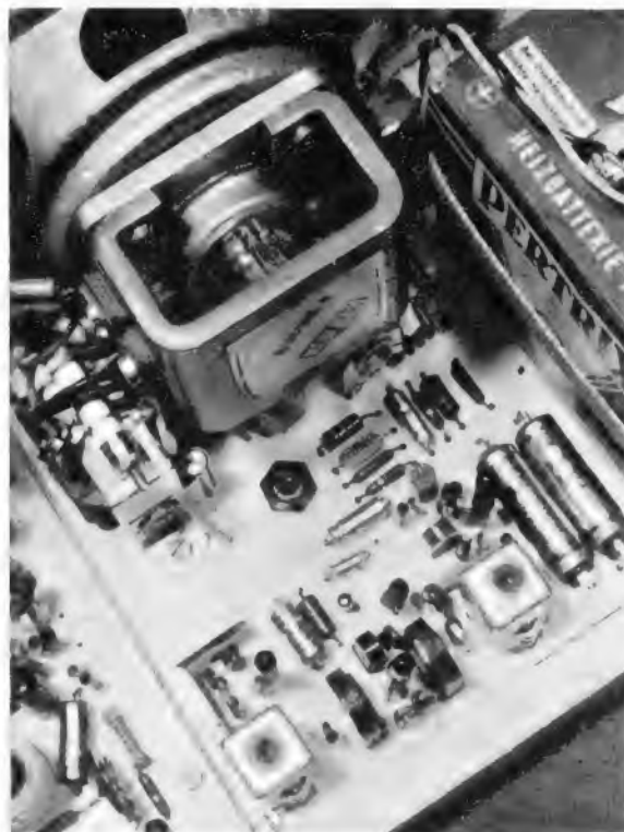
Rechts: Bild 8. Im rechten Chassis-teil - von rückwärts gesehen - sind Zf-Stufen, Demodulator (im Vordergrund) und der Nf-Verstärker mit Lautsprecher sowie die 9-V-Batterie (rechts oben) untergebracht
