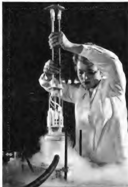
Ein neuer vierteiliger Bandleitungs-zirkulator für den 4-GHz-Bereich im Temperaturbereich zwischen 4,2 °K und 77 °K entsprechend -289 °C und -196 °C
