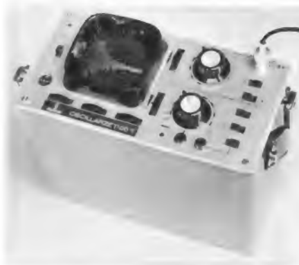
Bild 5. Netzunabhängiger tragbarer Oszillograf von Siemens
