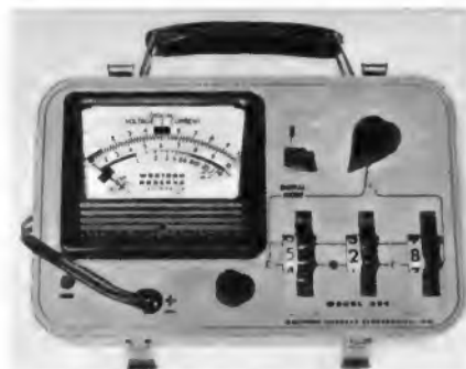
Bild 4. Vielfachmeßgerät, umschaltbar auf passive Digitalablesung (Vertrieb Neuberger)
