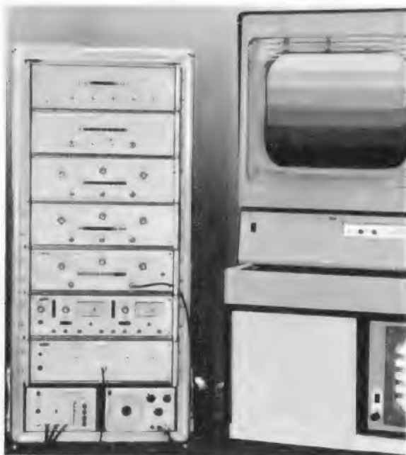
Bild 6. Farbfernsehmeßplatz der Philips Industrie Elektronik für Labor- und Prüfzwecke
