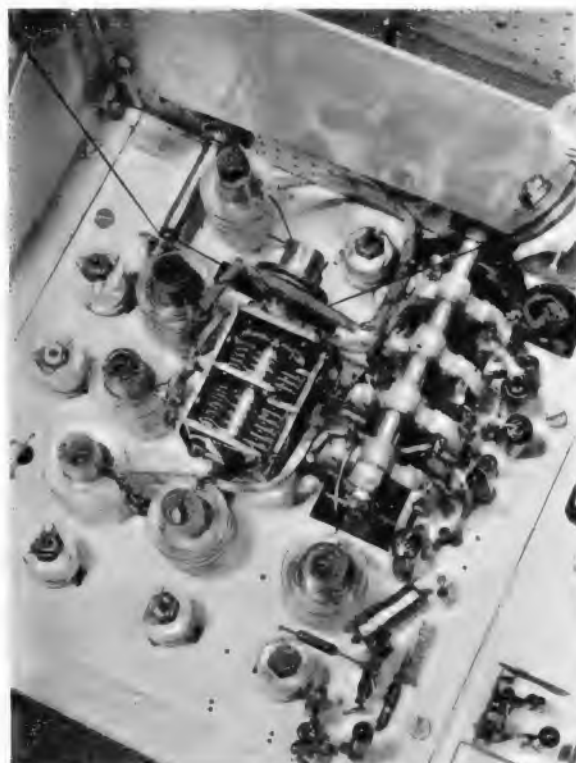
Links: Bild 7. Teilansicht der Hochfrequenzstufen mit Drehkondensator, Bandumschalter und Spulensätzen
