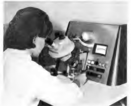
Die Mikrominiatur-Schweißmaschine Typ 800 dient zum Verbinden von Drahtanschlüssen mit Halbleiter- und Dünnschicht-Metallschichten
