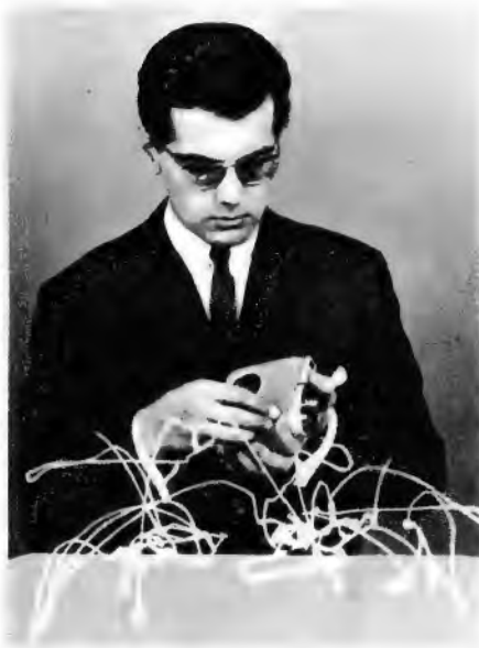
Bild 8. Das Einlegen eines Filmes in eine Kamera konventioneller Bauart. Die dabei notwendigen Handbewegungen sind durch Leuchtspuren kenntlich gemacht
