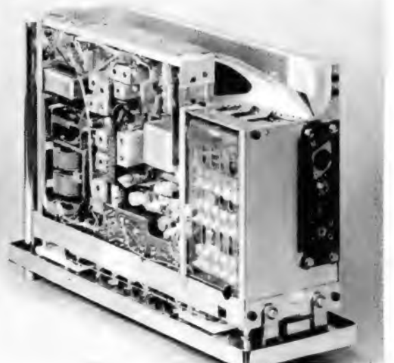
Bild 9. Schaltung des KW-Tuners im Grundig-Satellit
