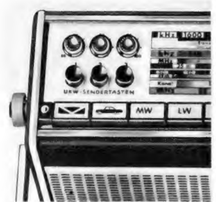
Bild 1. Die drei Stationstasten des Reiseempfängers Bajazzo de Luxe mit den darüberliegenden Abstimmknöpfen
