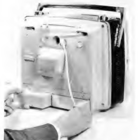
Bild 14. Rückansicht des Astronaut 1819: Die beiden Dryfit-Batterien und das Ladegerät werden in eine eigene Tasche eingeschoben
