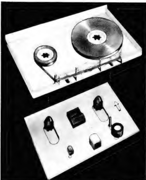
Bild 6. Prinzip der Kassette „DC-International“
