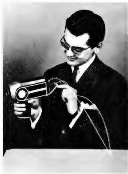
Bild 9. Der gleiche Vorgang beim Laden einer modernen Kamera, für die der Film in einer Kassette untergebracht ist
