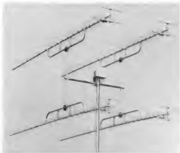
Bild 4. Kombination von vier Fuba-Antennen AMD 22 für die Amateur-Fernsehübertragung während der Funkausstellung
