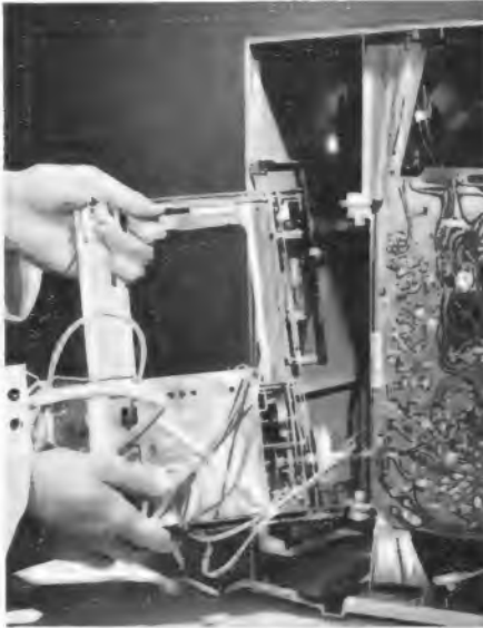
Bild 1. Die Baueinheit des Allbereich-Kanalwählers lößt sich komplett mit dem Seiltrieb an einer Führungsschiene nach Lösen von zwei Rändelschrauben herausziehen (Kuba/Imperial)
