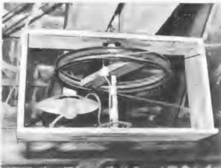
Bild 2. Die Anordnung des Seilrades mit dem Zugseil und dem Seil für das Gegengewicht
