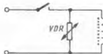
Bild 23. Der VDR-Widerstand parallel zur Induktivität verhindert hohe Spannungsspitzen beim Ausschalten des Stromes; dem Funktechniker ist diese Anwendung bei den Bildkipp-Ausgangsübertragern in Fernsehgeräten bekannt
