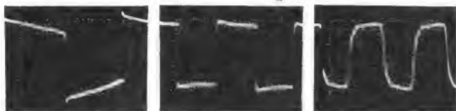
Bild 8. Überalles-Impulsbilder am Ausgang für die Frequenzen 40 Hz (links), 1 kHz (Mitte) und 10 kHz (rechts)
