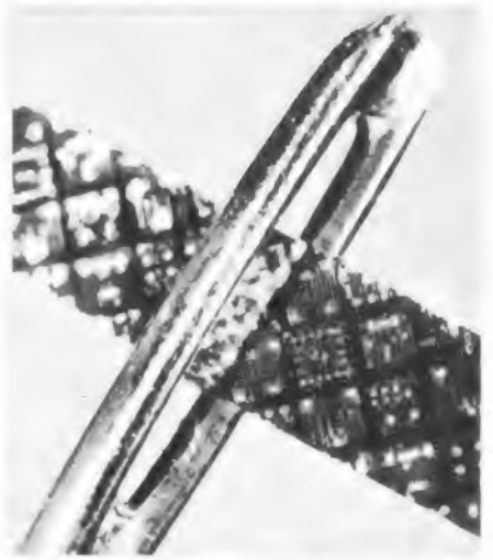
Kein Kamel, aber eine integrierte Schaltung geht hier durch ein Nadelöhr. Das Bild stammt aus dem Elliot-Forschungslaboratorium für Mikroelektronik. Der kleine Streifen ist Teil einer integrierten Schaltung in Dünnfilmmtechnik
