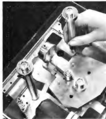
Bild 4. Kontrolle der Senkrechtstellung der Wickelteller-Achsen. Dazu dienen Libellen (Wasserwaagen); mit einer solchen Libelle wird auch die Kopfträgerplatte „eingetaumelt“
