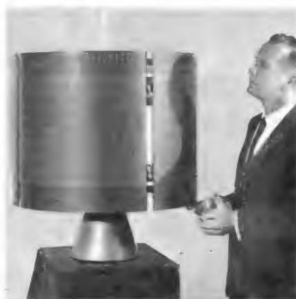
Bild 1. Modell des Syncom-Satelliten Nr. 1. Die Außenseite ist mit Fotoelementen besetzt. Nach unten ragen vier dünne Antennenstäbe heraus
