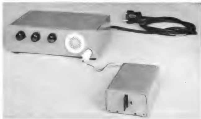
Bild 1. Gesamtansicht der vollautomatischen Taste. Vorn rechts die Taste, die über ein Kabel mit dem Elektronikteil verbunden ist
