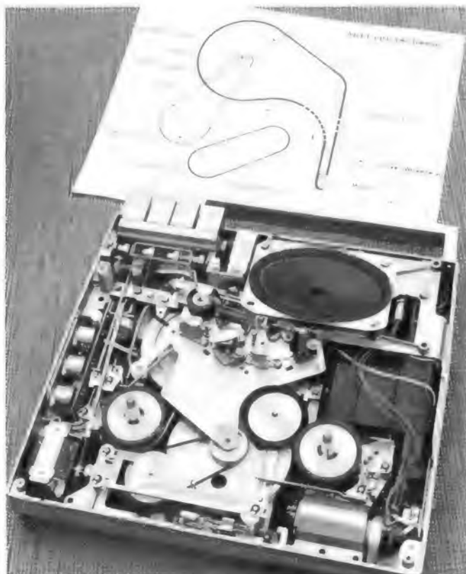
Bild 1. Chassis des Telefunken-Tonbandgerätes M 300 mit schematischer Darstellung des Antriebs
