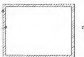
Bild 1. a = kleinstmögliche Einstellung der verdeckten Bildränder, Verlust etwa 10 %; b = normale Einstellung mit Rücksicht auf Netzspannungsschwankungen, Verlust etwa 15 %; c = Bildfensternorm beim 8-mm-Schmalfilm, Verlust des Projektorbildes etwa 16 %
