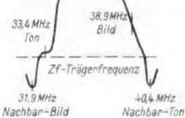
Bild 5. Gesamtdurchlaßkurve des Zwischenfrequenzverstärkers
