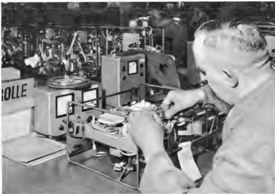
Kontrollplatz für die Lauffunktionen der Geräte
