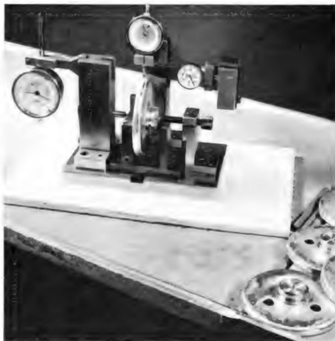
Bild 2. Vorrichtung zum Messen der Plan- und Rundlaufabweichungen bei den Schwungscheiben
