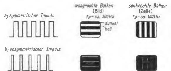
Bild 5. Rechteckimpulse und ihre Abbildung auf dem Bildschirm
