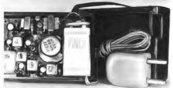
Rechts: Das Gerät Pinex-Nova ersetzt eine 9-V-Transistorbatterie in einem Taschensuper. In dem zugehörigen Netzstecker rechts befindet sich der kleine Netztransformator mit dem Netz isolierter Sekundärwicklung
