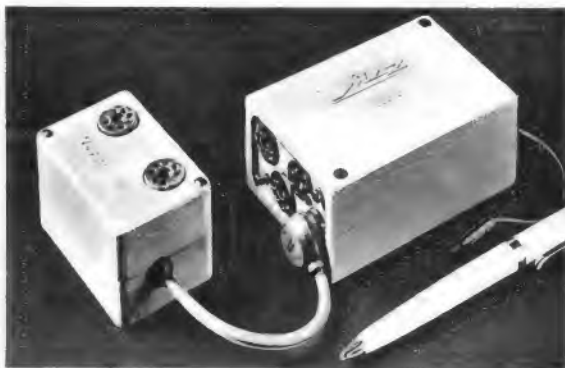
Bild 4. Der vollständige Zehnkanelempfänger bestehend aus den Einheiten 195/2 und 195/4
