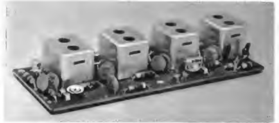
Bild 1. Ansicht des Zf-Bausteins von Görler
