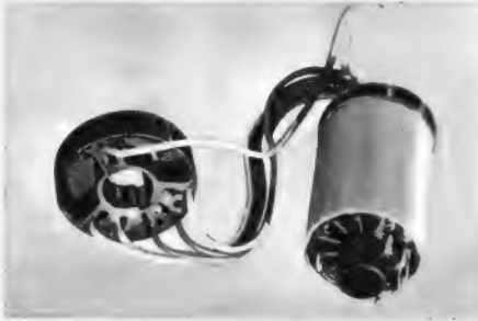
Dieser Adapter wird bei einer verbrauchten Bildröhre zwischen Sockel und Fassung gesteckt. Durch Überheizung des Fadens werden die Emission und damit die Helligkeit wesentlich besser.
