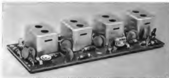
Bild 1. Ansicht des Zf-Bausteins von Görler
