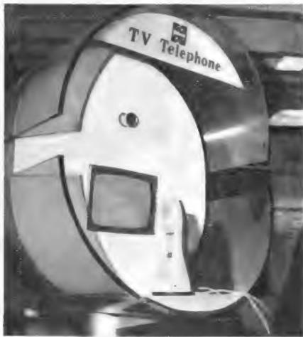
Die Fernseh-Telefonanlage von Matsushita mit Transistor-Gegensprechergerät. Dieses Demonstrationsmodell war auf dem japanischen Ausstellungsschiff Sakura Maru zu sehen
