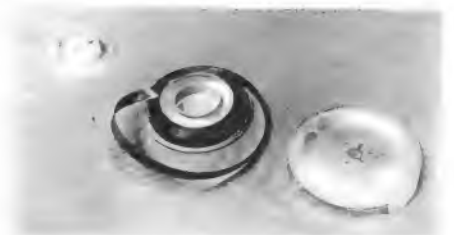
Bild 2. Die Einzelteile der Endlos-Spule, links der Kern, in der Mitte die Spule mit dem Band, rechts der große Spulenflansch mit dem Austrittsschlitz
