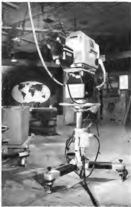
Bild 3. Eine ferngesteuerte Kamera mit Schwenk- und Neigekopf sowie Antrieb für Zoomeffekt und Fokus
