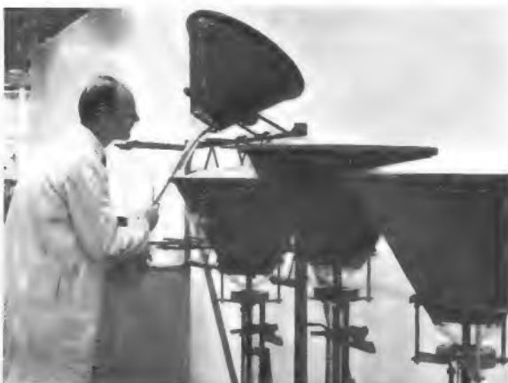
Radarbildröhren mit flachem Schirm aus hochwertigem Spezialglas und Metallkolben. Rechts: Aufbringen des Alu-Films, links: Auspinseln des Konus mit elektrisch leitfähiger Paste
