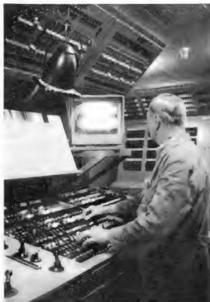
Bild 1. Auf der Stellwarte wird die Beleuchtung für die soeben laufende Szene eingestellt. Der Beleuchter verfolgt das Bühnenbild auf einem Sichtgerät des Kurzschluß-Fernsehens. An der Tasche des Arbeitsmantels steckt der Transistorempfänger für die UKW-Sprechfunk-Anlage. Im Hintergrund ist die Speicherwarte zu sehen, auf der die Beleuchtung für vier Bilder im voraus eingestellt werden kann. Die gespeicherten Lichtwerte werden vom Meisterpult auf die Stellwarte abgerufen und können von dort auch wieder in den Speicher zurückgegeben werden.
