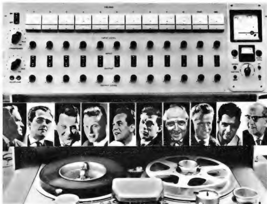
Ein Mehrspur-Tonaufzeichnungsgerät von Telefunken, das „Magnetophon M 10“, bietet bei großen internationalen Veranstaltungen, beispielsweise bei den Olympischen Spielen in Tokio, zehn Fernsehkommentatoren der Wettkämpfe die Möglichkeit, zu gleicher Zeit ihre Berichte zu den gefilmten Ereignissen auf ein 12-Spur-Tonband zu sprechen. Der Pegel jedes Aufnahme- und Wiedergabekanals ist einstellbar. Mit Hilfe einer Pegelmeßschaltung pro Kanal kann die Aussteuerung in allen zwölf Kanälen gleichzeitig überwacht werden.
