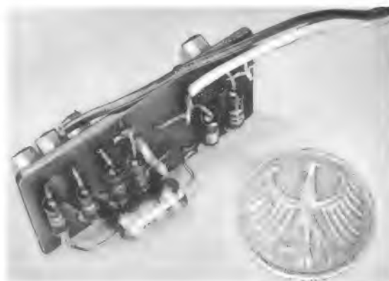
Bild 2. Zweistufiger Summer mit niederohmigem Ausgang, Widerstände 0,25 Watt, Kondensatoren 125 V
