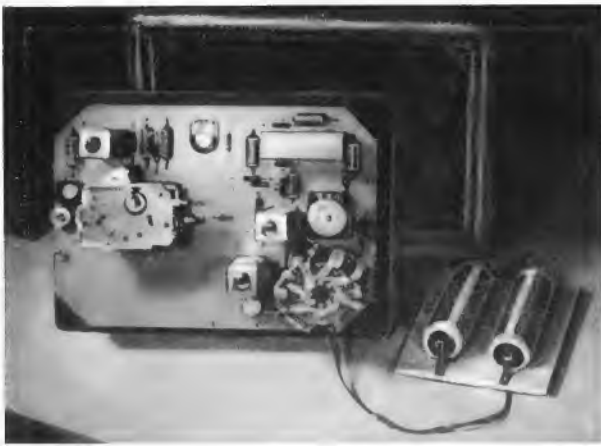
Bild 5. Blick auf die Leiterplatte; links der Oszillatorteil, rechts der Anzeigeteil
