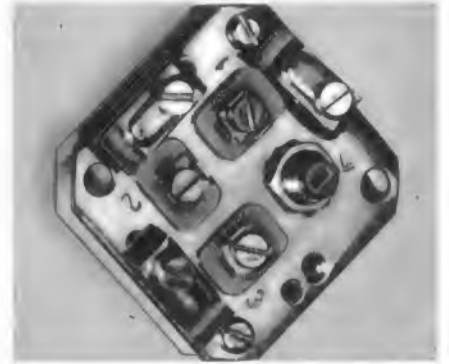
Abzweigdose für Stammleitungen mit einstellbarer Dämpfung von 0 bis 20 dB (Telo)
