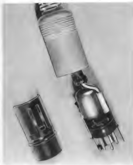
Bild 4. Der kleine Kabelanpassungsübertrager ist im Innern eines normalen Diodensteckers untergebracht (Bild in natürlicher Größe!)
