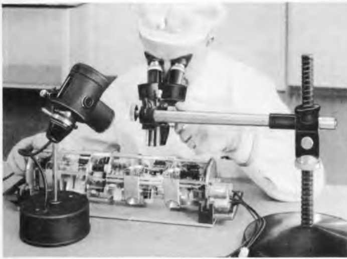
Montage am ICECAN Verstärker
