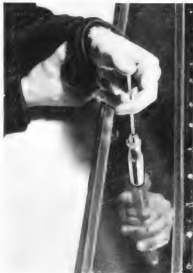
Bild 11. Prüfen der Membranspannung. Das Prüfgewicht soll ungefähr 18 mm Durchmesser haben und 25 g wiegen. Es wird an mehreren Stellen längs der Mittelachse auf den flachliegenden Lautsprecher gestellt. Dabei darf das Gewicht die Membran noch nicht ganz auf die Unterlage drücken, das heißt, mit dem kleinsten Fingerdruck muß die Membran aufschlagen
