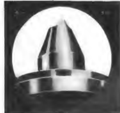
Bild 5. Übermäßig abgenutzte Spitze, sie bewirkt starke Verzerrungen beim Abspielen und ruiniert die Schallplatten
