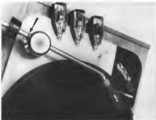
Bild 4. Sehr abgenutzte Spitze; der Saphir muß unbedingt ersetzt werden
