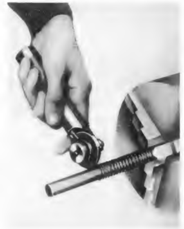
Das Federwickelgerät Spring-Winder der Firma Microtechnic läßt sich ohne lange Einrichtungszeiten verwenden. Mit etwas Geschick können die Federn anstatt auf einer Drehbank auch mit Hilfe einer Handbohrmaschine gewickelt werden
