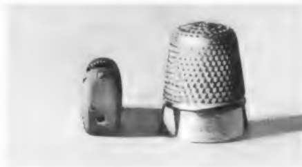
Der Miniatur-Hörapparat wiegt nur 5,6 Gramm und enthält dennoch ein Mikrofon, den Verstärker und Hörkapsel
