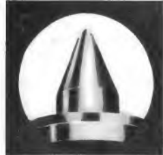
Bild 4. Sehr abgenutzte Spitze; der Saphir muß unbedingt ersetzt werden
