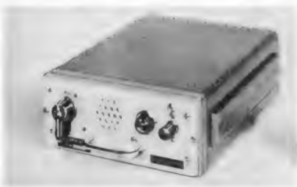
Bild 3. Autorufempfänger RE 23. Auf der Frontplatte von links nach rechts: Betriebsschalter, Öffnungen für den Ruflautsprecher, Ruflampe, Taste für Rückstellung und Empfangskontrolle
