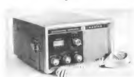
Amerikanisches Funksprechgerät für das 11-m-Band für Netz- und Batteriebetrieb
