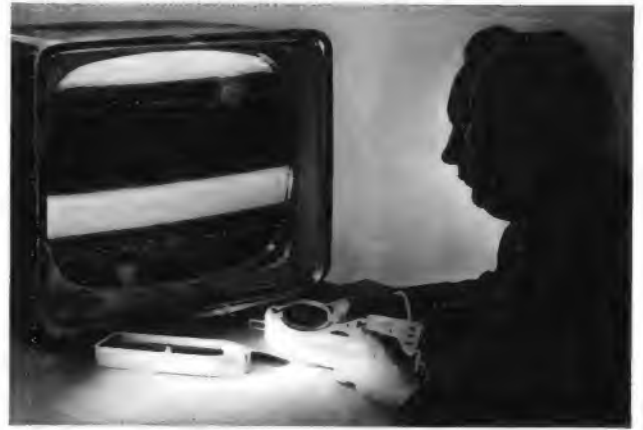
Bild 12. Das Dipmeter als Fernseh-Signalgenerator
