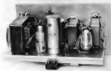
Bild 6b. Innenansicht; die Röhre rechts neben dem Netztransformator gehört zum Netzteil; rechts neben den Elektrolytkondensatoren der Zwischenübertrager, ganz rechts der Eingangübertrager
