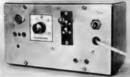
Bild 6a. Außenansicht des Versuchsgerätes; mit dem Kelloggschalter kann die Brücke G1 2 abgeschaltet werden
