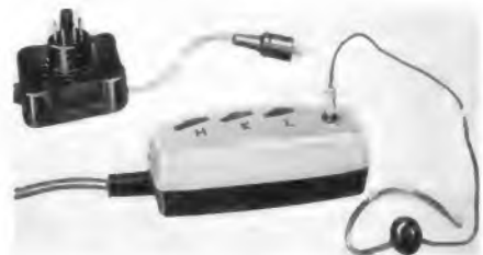
Fernbedienung für Fernsehempfänger, mit Anschlußmöglichkeit für einen Ohrhörer
