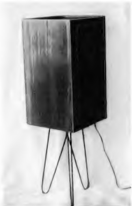
Bild 1. Ansicht der Lautsprecherbox. Sie besteht aus glatten furnierten Brettern, die Schallöffnungen befinden sich oben und unten
