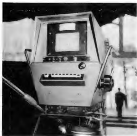
Bild 2. Transistorisierte französische Studiokamera für drei Normen mit 4 1/2-Zoll-Image-Orthikon und 17-cm-Bildröhre für den elektronischen Sucher (Bedienungselte)
