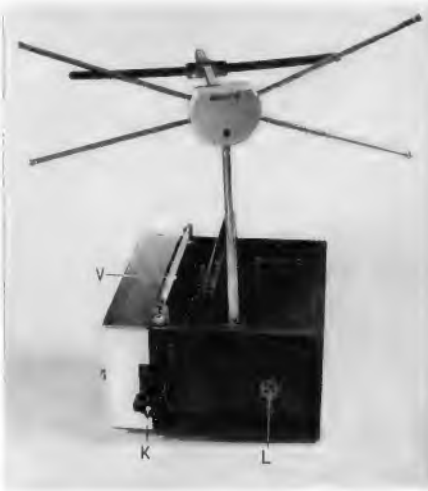
Sony-Micro-TV 5-303 E mit nachträglich innen eingebauten UHF-Tuner, der durch ein Loch L in der Seitenwand nachstimmbar ist; V = unbenutzte VHF-Antenne, K = Knebelknopf (Foto: Eduard Rhein)
