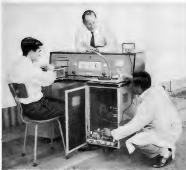
Bild 3. Vier solcher kompakter Einschubverstärker PA 140 ermöglichen die Konstruktion dieser 500-W-Mischpultzentrale im Schreibtischformat. — Wir benutzen diese Gelegenheit, den Lesern unseren Mitarbeiter Hans J. Wilhelmy (in der Mitte) vorzustellen, der nun schon bald seit 30 Jahren für die FUNKSCHAU schreibt
