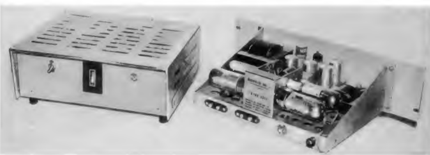
Bild 2. 125-W-Verstärker nach Bild 1 im Flachgehäuse und für Gestelleinbau
