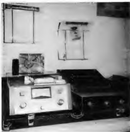
Bild 5. Spotmaster 500 A, ein Kassetten-tonbandgerät zum Einblenden von „commercials“ in Hörfunk- oder Fernsehsendungen
