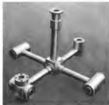
Bild 2. Keine Stahlrohrverschraubung des Turmes, sondern einen Verteilungstransformator zum Speisen der Einzelantennen stellt dieses Bild dar
