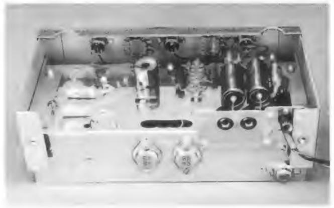
Bild 7. Unterhalb des Chassis sind die größeren Niedervolt-Elektrolytkondensatoren und die Drossel Dr für die Tiefenanhebung untergebracht. Durch entsprechende Aussparungen im Gehäuse sind die Ausgangsbuchsen und das Sicherungselement zugänglich
