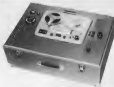
Bild 1. Fahrzeuganlage bei abgenommenem Deckel. Der Holzkoffer enthält den Verstärker sowie die Regel- und Kontrollorgane zusammen mit einem Magnetophon 85 T
