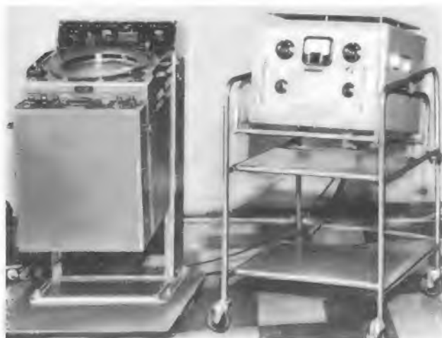
Bild 1. Links Sichtgerät des Radars, rechts Steuerpult des „Eigenschiffes“ mit Geschwindigkeitsmaß
