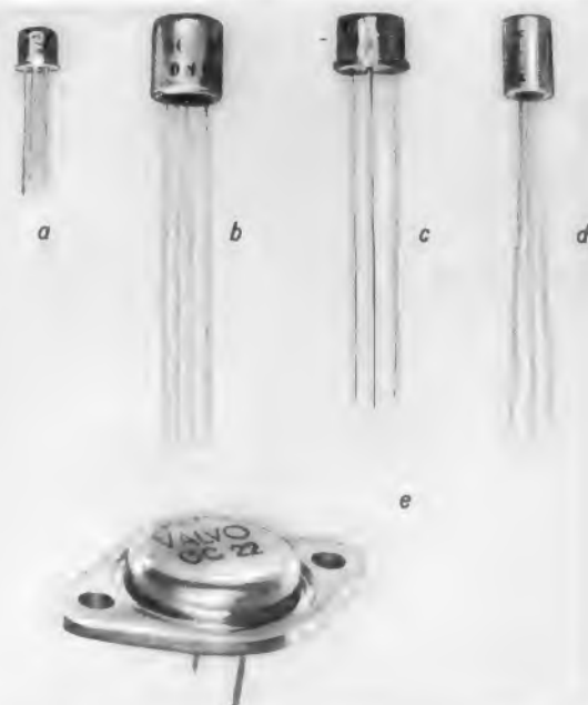
Einige Beispiele von Jedec-Gehäusen, dargestellt an Valvo-Transistoren: a = TO-18, b = TO-7, c = TO-5, d = TO-1, e = TO-3
