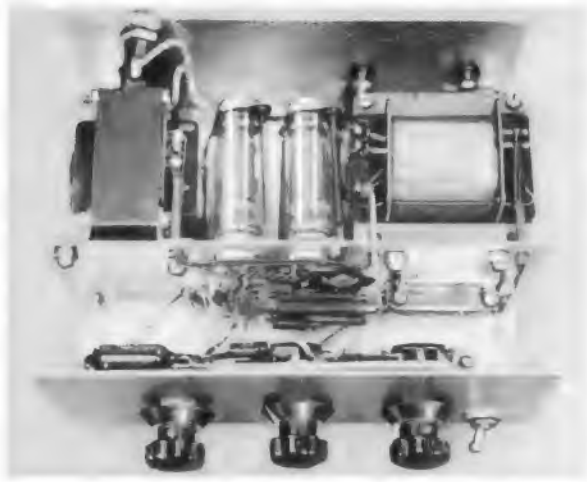
Bild 12. Blick von oben in den geöffneten Verstärker, die Endröhren sind mit Spannfederhalterungen gesichert
