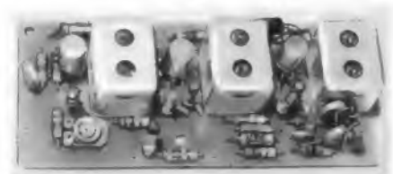
Bild 4. Printplatte des Zf-Verstärkers von der Bestückungsseite gesehen
