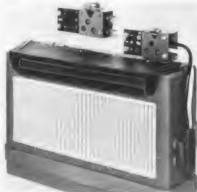
Bild 3. Oberteil eines Empfängers Twentie, vorbereitet für den Betrieb aus der Wagenbatterie; rechts oben das stets notwendige Sieb- und Anpassungsglied für 6 V, in der Mitte oben das zusätzlich für den 12-V-Betrieb erforderliche Vorsatzgerät
