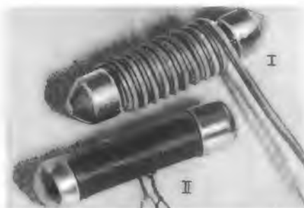
Bild 1. Glimmröhren mit aufgewickelten Drahtbelägen als steuerbare Kapazitäten
