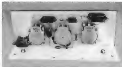
Bild 14. Ansicht der Verdrahtung der Klang- und Lautstärkeinsteller
