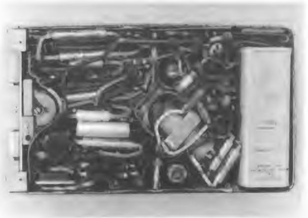
Bild 36. Das vollständig bestückte und verdrahtete Chassis
