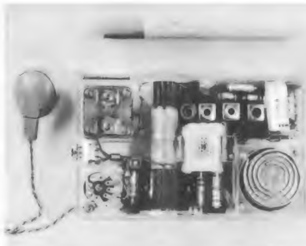
Bild 15. Das Mustergerät ist in ein durchsichtiges Kunststoffgehäuse eingebaut, das etwa die Größe einer Zigarettschachtel aufweist
