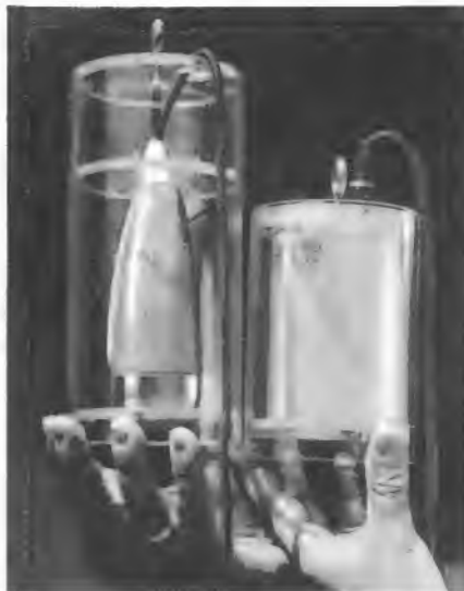
Bild 1. Dynamisches Mikrofon GDM 121 und Kleinstsender der Anlage GSE 230 in Kunstglas-hüllen zum Schutz gegen Hitze und Staub
