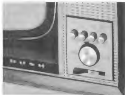
Ein raumsparender „1964er-Schalter“ nach den Empfehlungen des Pilkington-Ausschusses zum einfachen Umschalten von 405 auf 625 Zeilen in einem Empfänger der Firma Bush
