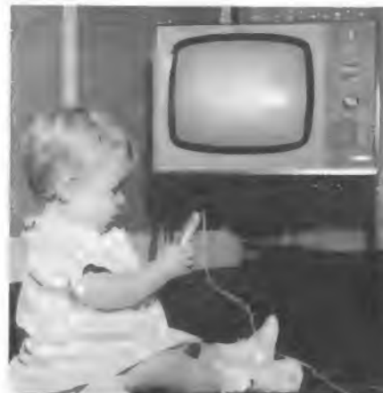
Babysitter-Mikrofon auch in England. Einige Fernsehempfänger wurden mit einem Anschluß für eine Kleinkinder-Alarmvorrichtung ausgerüstet, da wohl am Abend die Eltern vor dem Fernsehgerät sitzen werden. Die Alarmvorrichtung besteht aus einem Mikrofon, das neben dem Bettchen aufgehängt wird, etwa 15 m Kabel und einem Transistorverstärker zum Anschließen an den Fernsehempfänger
