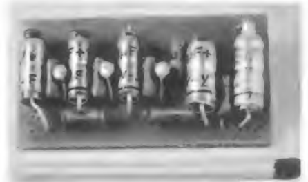
Rechts: Bild 14. Printplatte des Nf-Verstärkers im Größenvergleich zu einem Streichholz. In der Mitte sind die drei runden Subminiatur-Transistoren AC 129 zu erkennen
