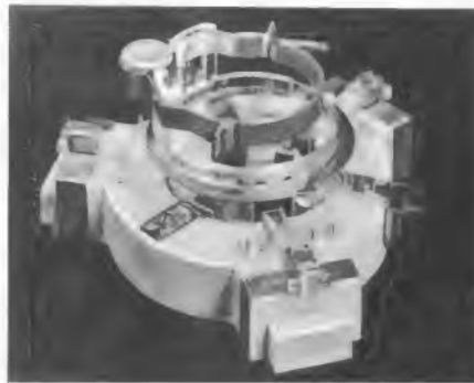
Elektronenstrahl-Konvergenzgerät zur Verwendung für Farbfernsehbiröhren mit eingebauter Lochmaske (Mullard Ltd.)
