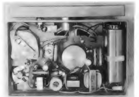
Bild 3. Die Innenansicht des nur mit zwei Transistoren ausgerüsteten Gerätes
