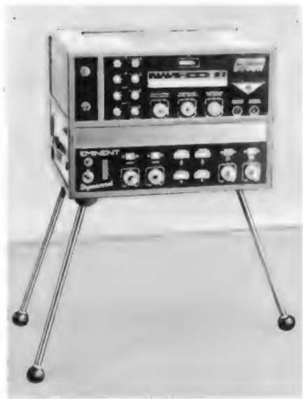
Moderne Musikeranlage von Dynacord. 45-W-Verstärker mit dem Hallgerät Echocord kombiniert
