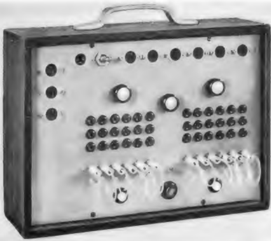
Bild 6. Die Frontseite des Kreuzschaltfeldes
