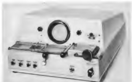
Elektronisches Video-Schneidergerät für bildstrichgenaue Schnitte von Fernseh-Magnetbandaufzeichnungen (nach Schürer)
