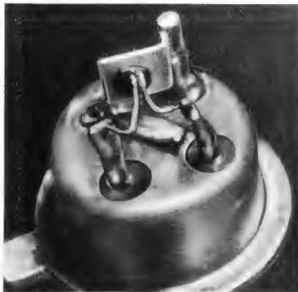
Bild 2. Das System des Intermetall-Transistors AF 129 vor dem Einsetzen in das TO-18-Gehäuse
