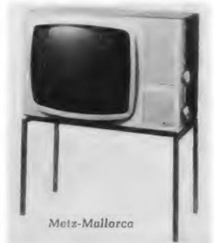
Automatiken für Bildgröße, Störaustattung, Zeilenfang und Schwarzpegelhaltung. Der große ovale Lautsprecher ist neben der Bildröhre angeordnet und strahlt nach vorn, die Bedienungselemente sind übersichtlich rechts am Frontrahmen angebracht. Abmessungen des Gerätes: 76 cm × 49 cm × 36 cm.
