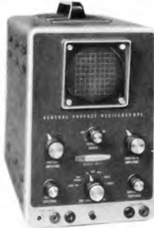
**Technische Daten:** Verstärker: X = Y (2 dB von 2 Hz... 200 kHz); Empfindlichkeit: 0,25 V<sub>eff</sub> / Raster-Teilung; Eingangsimpedanz: 10 MΩ 20 pF; 7 cm-Kathodenstrahlröhre 3 RP-1 mit kontrastreichem, abnehmbarem Meßraster; Netzanschluß 220 V / 50 Hz / 40 W; Maße: 245 x 170 x 255 mm; Gewicht: 4,2 kg.
