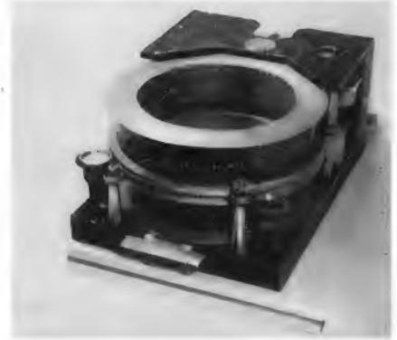
Klein-Magnetbandgerät von Ampex für den Einbau in Satelliten. Raumbedarf: 0,02 cbm
