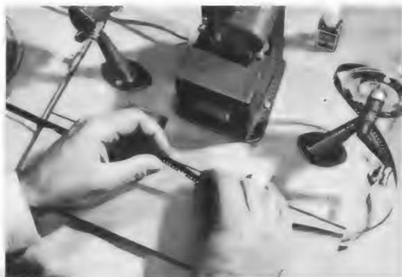
Bild 5a. Unter Berücksichtigung des Bild-Kontaktabstandes können die Klebefolien bereits bei der Durchsicht des Filmes am Betrachtungsgerät aufgeklebt werden
