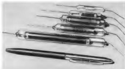
Bild 13. Hochstabile Kohlewiderstände in edelgasgefüllten Glasröhrchen von Tesla
