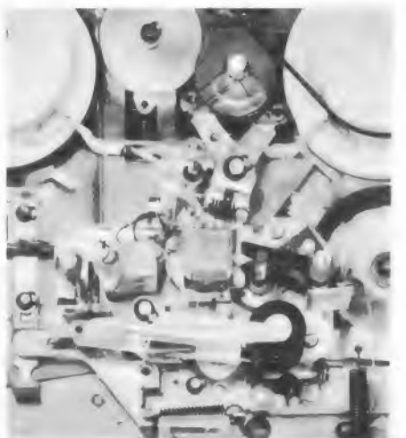
Bild 3. Die solide mechanische Konstruktion: Teilansicht der Kopfanordnung und des Bandantriebs
