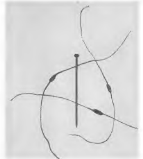
Drei Karbowid-Kleinstwiderstände im Größenvergleich zu einer Stecknadel
