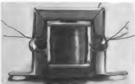
Bild 2a. Das aus einem M-30-Transformator Kern und zwei Ferritrohrkernen bestehende Magnetvariometer
