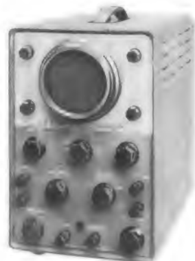
LBO-3 A Service-Oszillograph DM 399.- 1,5 Hz - 1,5 MHz
