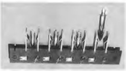
Bild 6. Fassungsleiste für die Lämpchen mit seitlichen Lichtabschirmungen
