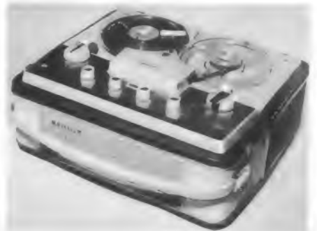
Bild 1. Das transistorbestückte Stereo-Heimtonbandgerät Philips RK 36
