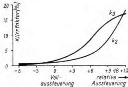
Bild 1. Ansteigen des Klirrfaktors infolge des Auftretens der zweiten und dritten Harmonischen ( $k_2$  und  $k_3$ )
