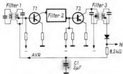
Die Prinzipschaltung des Zf-Teils mit den Transistoren T1 und T2 sowie den drei Zwischenfrequenzfiltern. Das beschriebene Zf-Schwingen wurde durch einen Ausfall des Kondensators C1 verursacht
