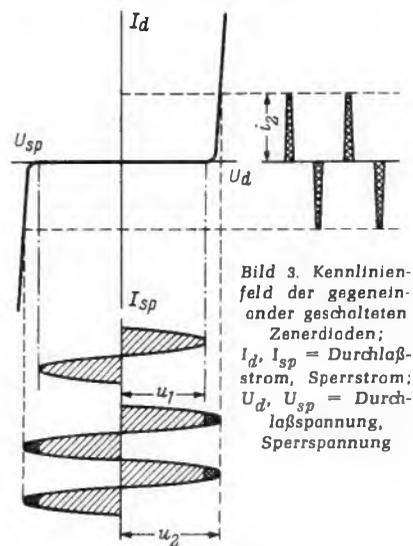
Bild 3. Kennlinienfeld der gegeneinander geschalteten Zenerdioden;  $I_d, I_{sp}$  = Durchlaßstrom, Sperrstrom;  $U_d, U_{sp}$  = Durchlaßspannung, Sperrspannung
