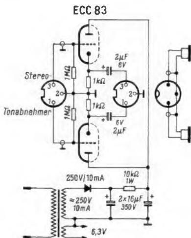
Bild 2. Schaltung eines einstufigen Stereoverstärkers zum Abhören von Schallplatten mit dem Kopfhörer
