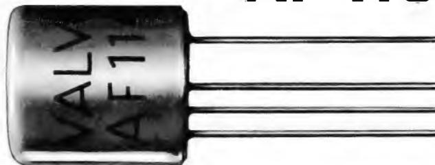
Für die Bestückung von volltransistorisierten AM/FM-Empfängern werden im UKW-Teil Transistoren benötigt, die bei 100 MHz eine hohe Verstärkung bei niedrigem Eigenrauschen haben. Die Entwicklung und Serienfertigung solcher Transistoren erfordert neue Bauformen und neue Herstellungsverfahren.
