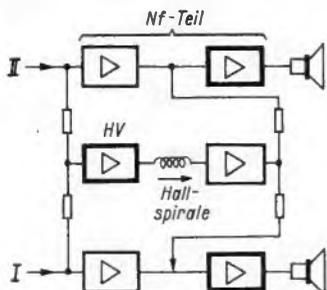
Links: Bild 1. Halleinrichtung über einen dritten Leistungsverstärker HV. Die Leistungsstufen sind stark gezeichnet
