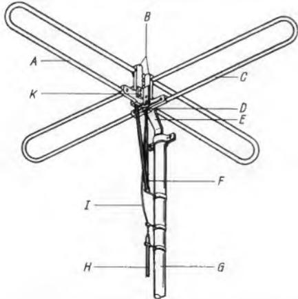
Bild 1. UKW-Rundempfangsantenne mit Kreuzdipol; A = Faltdipol 1, B = Haltekreuz, C = Faltdipol 2, D = Kabelhalter, E = Haltefuß, F = Verbindung aus 240- $\Omega$ -Flachbandkabel, 656 mm lang, G = Standrohr (verzinktes Wasserrohr), H = Ableitung aus 240- $\Omega$ -Flachbandkabel, I = Anpassleitung nach Bild 2, K = Winkel
