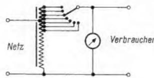
Bild 4. Zweckmäßige Anordnung eines Spartransformators zum Ausgleichen von Spannungsschwankungen des Lichtnetzes
