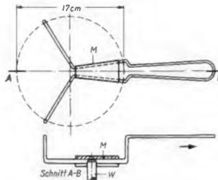
Bild 3. Die Polydor-Schallplattengabel. Der Drahtbügel erlangt seine Steifigkeit durch das Messingblech M. Letzteres dient im Betrieb zugleich zum Aufstützen auf die Wechslerachse W. Durch Wegziehen der mit Platten gefüllten Gabel in Pfeilrichtung wird die Wechslerachse zwangsläufig zu den Mittellöchern des Plattenstapels geführt
