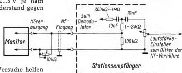
Bild 4. Die Anschaltung eines hochohmigen Kristallhorer an den Ausgang des Monitors
