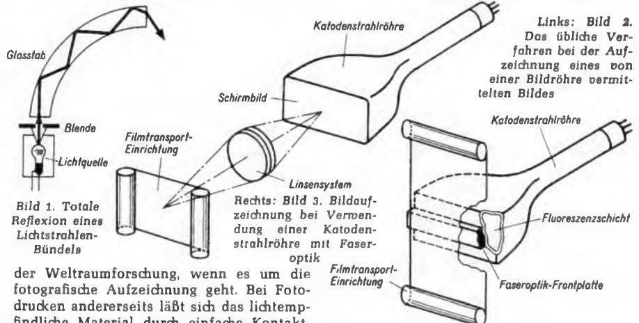
Bild 1. Totale Reflexion eines Lichtstrahlenbündels
