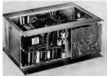
Ein transistorbestücktes elektronisches Netzgerät von Gossen & Co., als Baustein konstruiert
