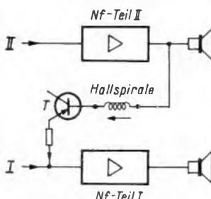
Rechts: Bild 2. Abnahme der Tribleistung für die Halleinrichtung aus einem Kanal des Nf-Teils
