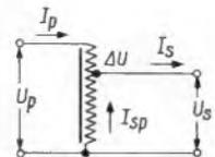
Bild 3. Spartransformator zum Herabsetzen einer Spannung
