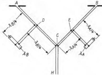
Bild 1. Prinzipschaltung der Antennenweiche VF 306/4 für zwei Kanäle im Bereich IV/V. A = Antenne für Kanal A; B = Antenne für Kanal B;  $\lambda_A$  und  $\lambda_B$  = unterkoppelte Kreise für die Frequenzen der Kanäle A und B; H = Niederführung
