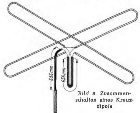
Bild 8. Zusammenschalten eines Kreuzdipols
