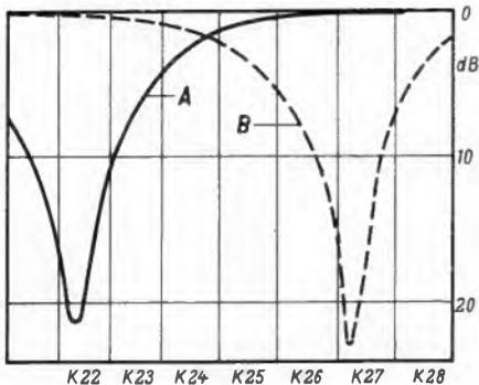
Bild 3. Durchgangs- bzw. Sperrdämpfung einer Antennenweiche VF306/4 für die Kanäle 22 und 27
