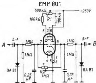
Schaltung der Stereo-Aussteuerungsanzeige mit der Röhre EMM 801; A = zur Anode der Endröhre des linken Kanals, B = zur Anode der Endröhre des rechten Kanals
