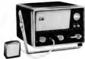
Mobile Funkstation im Citizens-Band für Netz/Batterie mit 4 Quarzfrequenzen, 2 stufiger Sender mit 5 W Input, 9-Kreis-Superhet-Empfänger.
