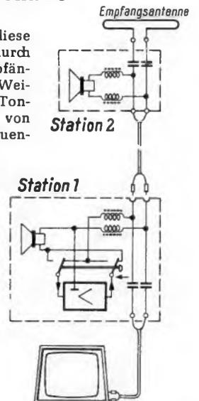
Bild 1. Prinzipschaltung des Fuba-Antennensprechgerätes
