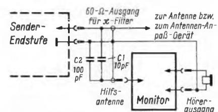
Bild 2. Die Ankopplung des Monitor-Eingangs an einen Spannungsteiler parallel zum Antennen-ausgang der Sender-Endstufe
