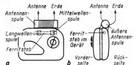
Die Antennenspule wird außen am Gehäuse des Reiseempfängers befestigt; a = Vorderansicht, b = Seitenansicht des Gerätes
