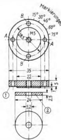
Rechts: Die beschriebene Bohrlehre (1) mit der Haltescheibe (2) in der Aufsicht und im Schnitt
