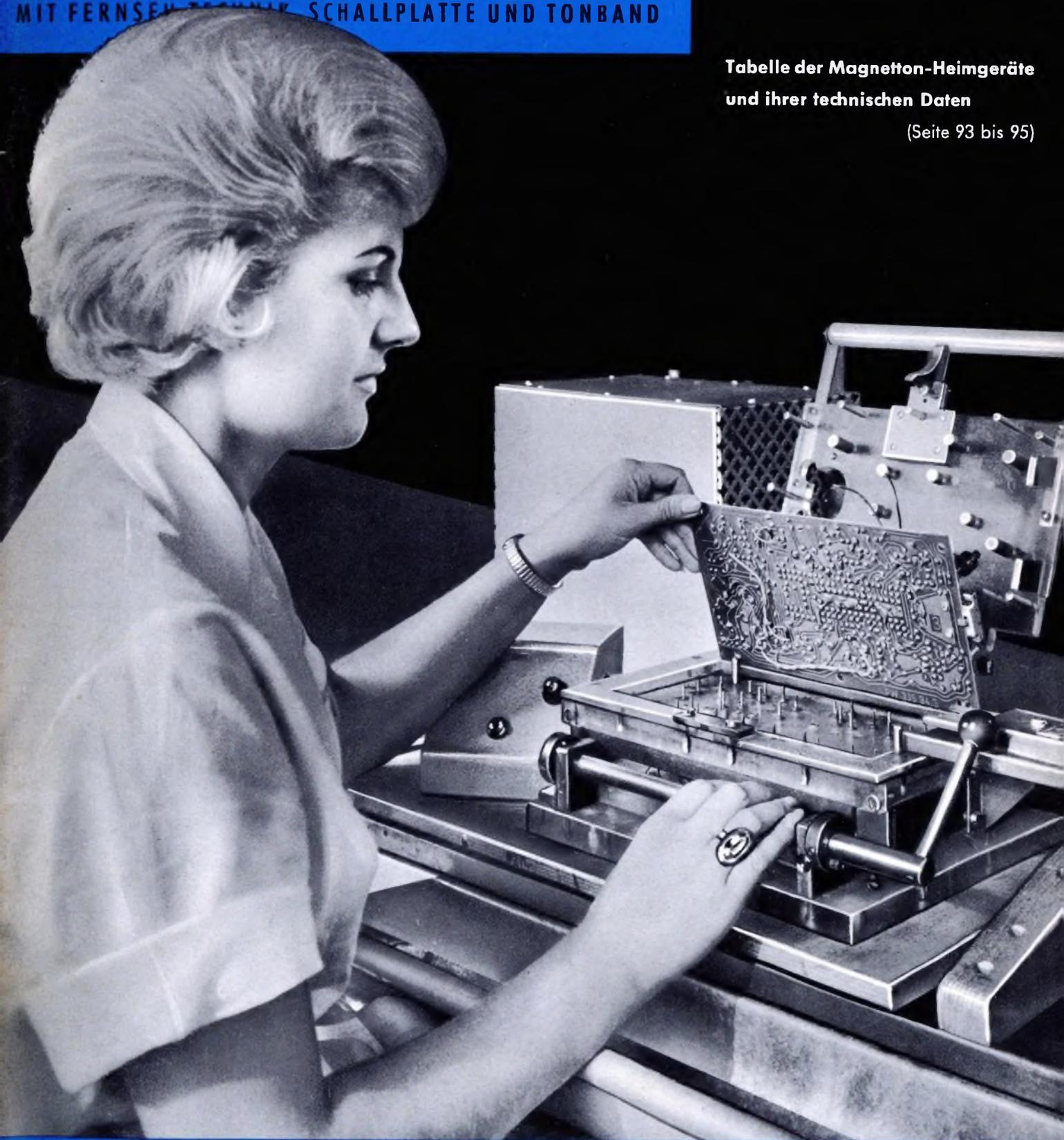
**Automatische Prüfeinrichtung für die
