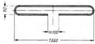
Bild 3. Faltdipol 1 und 2 (A und C in Bild 1); Werkstoff: Kupfer- oder Aluminiumrohr, etwa 10 mm Durchmesser
