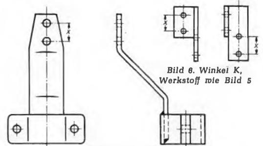
Bild 5. Haltefuß E; Eisenblech, 3 mm stark, verzinkt oder wetterfest lackiert
