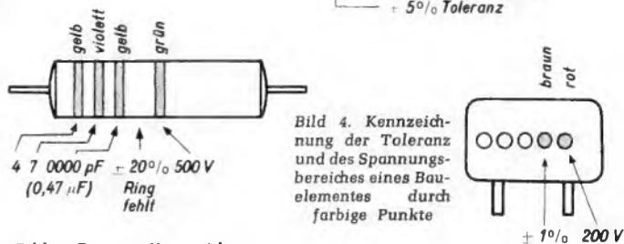
Bild 5. Gesamte Kennzeichnung eines Bauelementes
