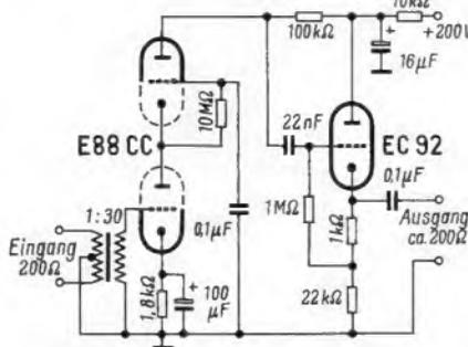
Der Mikrofonverstärker mit Kaskodenstufe und nachgeschaltetem Katodenverstärker
