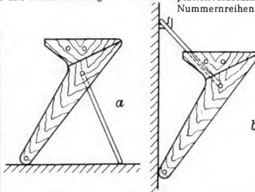
Bild 2. Seitenansicht des Hängeregisters für 30-cm-Platten; a = aufgestellt, b = der Stützbügel von Bild 2a wurde nach hinten herumgeklappt, das Register läßt sich nunmehr an der Wand befestigen
